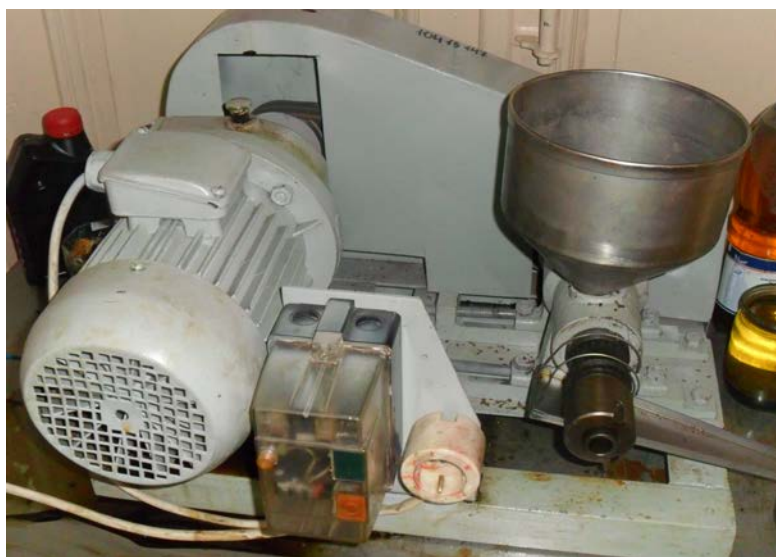
Рис 5. Пресове обладнання для визначення виходу олії
