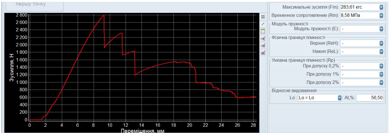
Рис. 3.2. Графік залежності зусилля - переміщення для попередньо напруженої балки ПНБ1000
