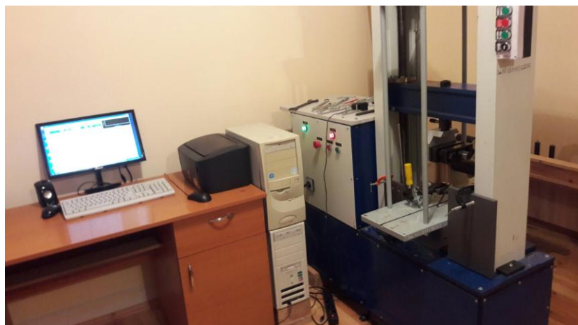
Рис. 3.1. Програмно-апаратний комплекс на базі розривної машини P5-M2
