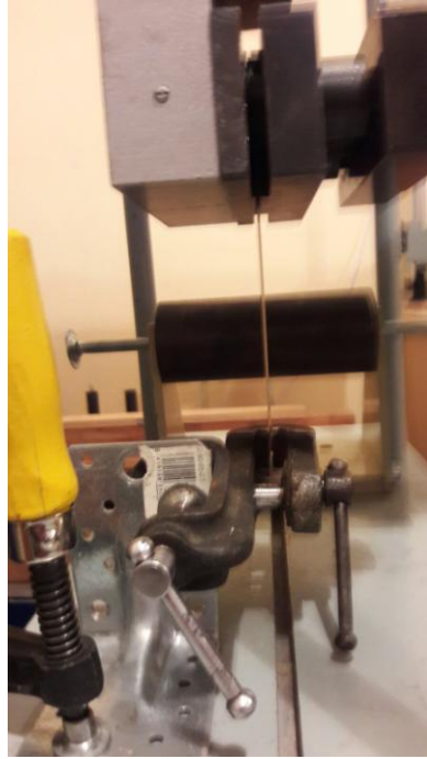
Рис. 3.2. Пристосування для випробувань на стійкість
