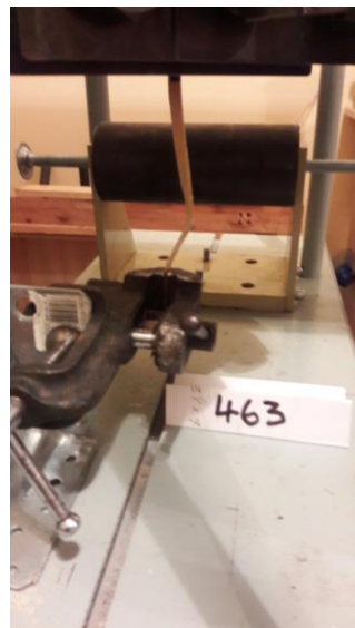
Рис. 3.16. Налаштування і деформування в часі стрижня конструкції ПККС - подвійний кручений клеєний стрижень.
