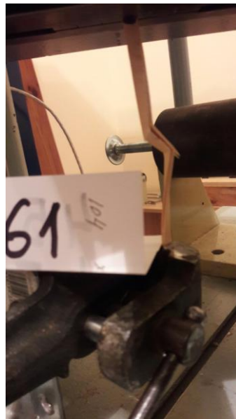
Рис. 3.14. Налаштування і деформування в часі стрижня конструкції ПККС-подвійний кручений клеєний стрижень.
