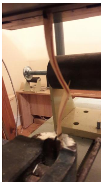
Рис. 3.12. Налаштування і деформування в часі стрижня конструкції ППКС- подвійний кручений клеєний стрижень.
