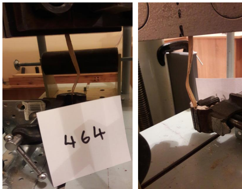
Рис. 3.18. Налаштування і деформування в часі стрижня конструкції ПККС- подвійний кручений клеєний стрижень.
