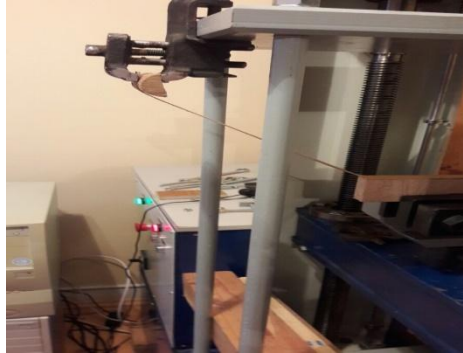
Рис. 3.5. Налагодження розривної машини РМ-М2 для випробувань міцності приклеювання керамічного матеріалу
