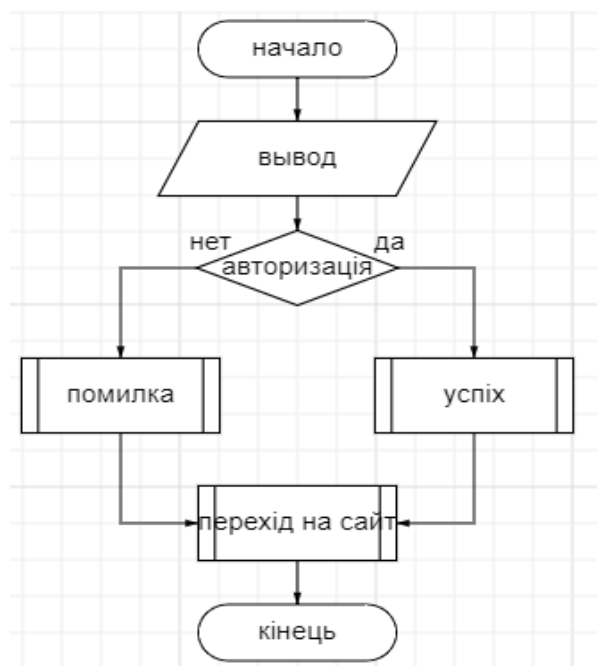
Рисунок 2.1 - Схема алгоритму авторизації
