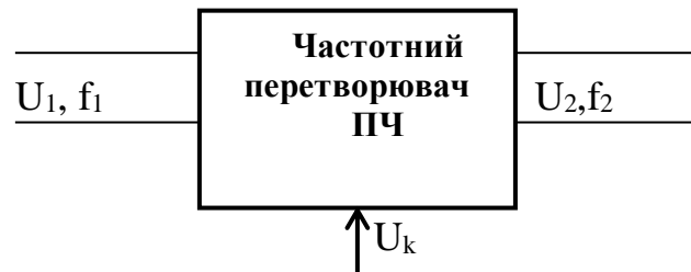
Рисунок 3.1 – Перетворювач частоти в електроприводі
