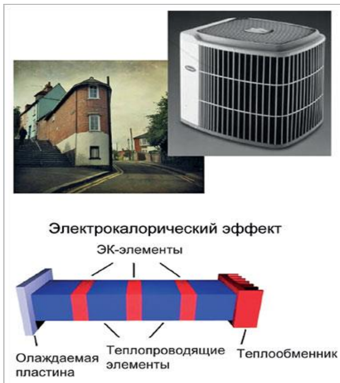
Рисунок 2. 3. Твердотільний тепловий насос для охолодження: зовнішній вид и схема роботи
