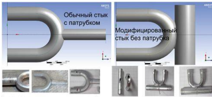
Рисунок 2. 1. Новий підхід в технології з'єднань деталей трубчатих змішувиків
