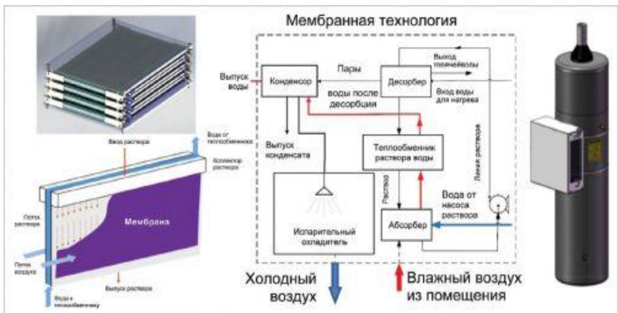
Рисунок 2.2. Блок-схема установки WHDC
