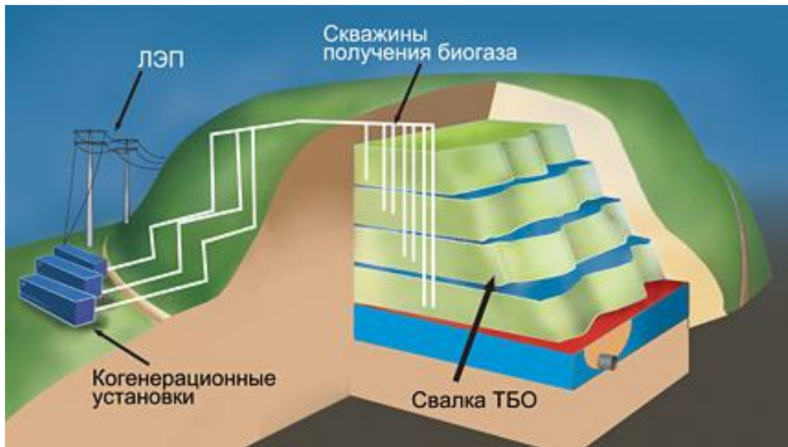
Рис.1.3. Схема живлення когенераційної біогазової електростанції на основі твердофазного виробництва біогазу
