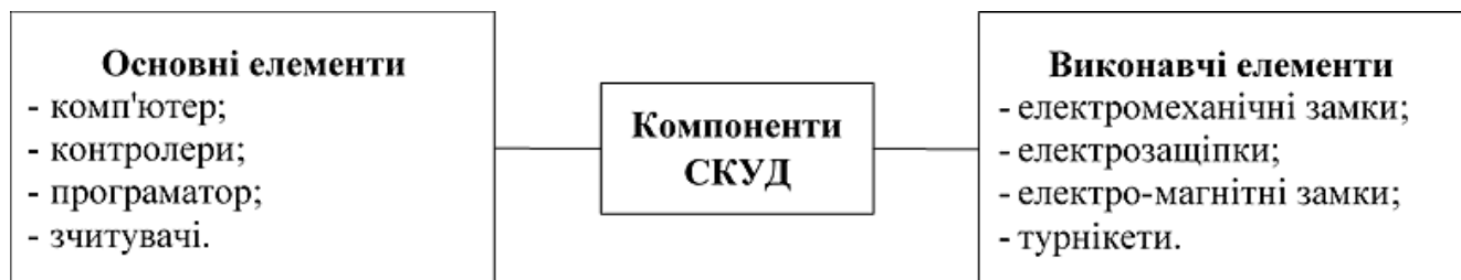
Рис. 2. Перелік основних та виконавчих елементів СКУД
