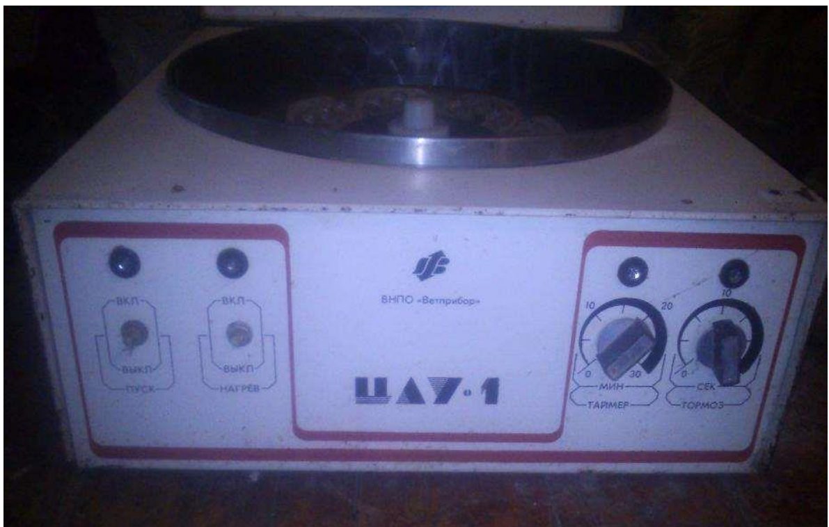
Рис. 3. Центрифуга лабораторна універсальна ЦЛУ-1 «Орбіта»
