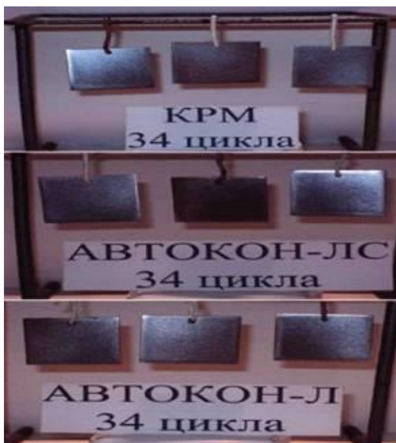
Рис. 3.9. Результати порівняльних досліджень для сталевих зразків.
