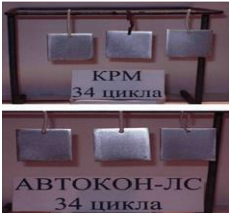
Рис. 3.12. Порівняльні дослідження захисних матеріалів для алюмінієвого зразку.
