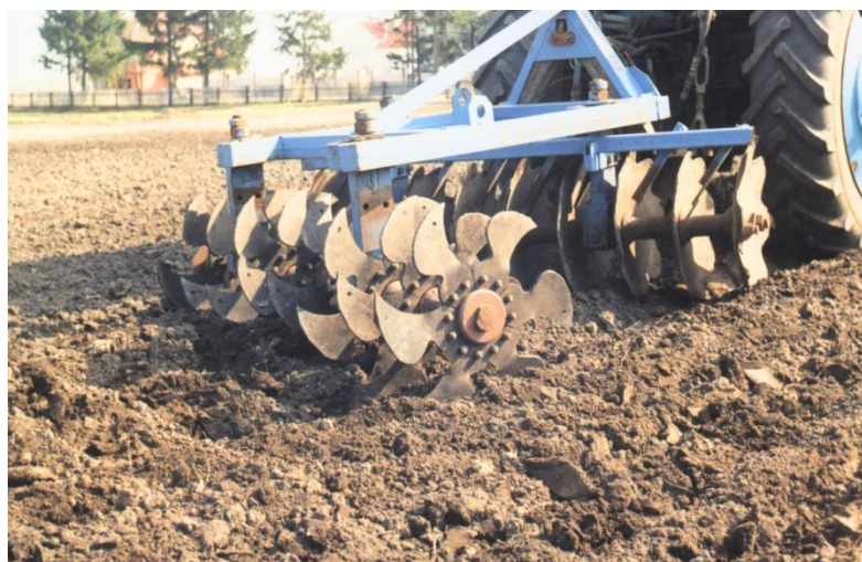
Рис. 1.3. Борона дискова БДН-1,8 з ротаційно-лопатевими робочими органами.
