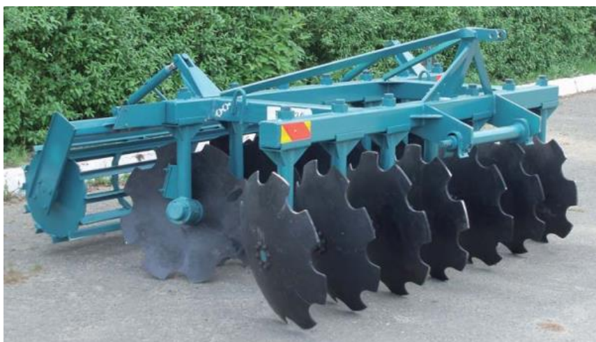
Рис. 1.2. Борона БДН-2 із індивідуальними стійками.
