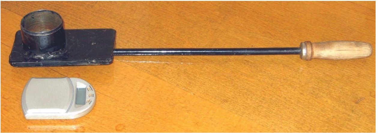
Рис. 3.6. Прилад для вимірювання щільності ґрунту.
