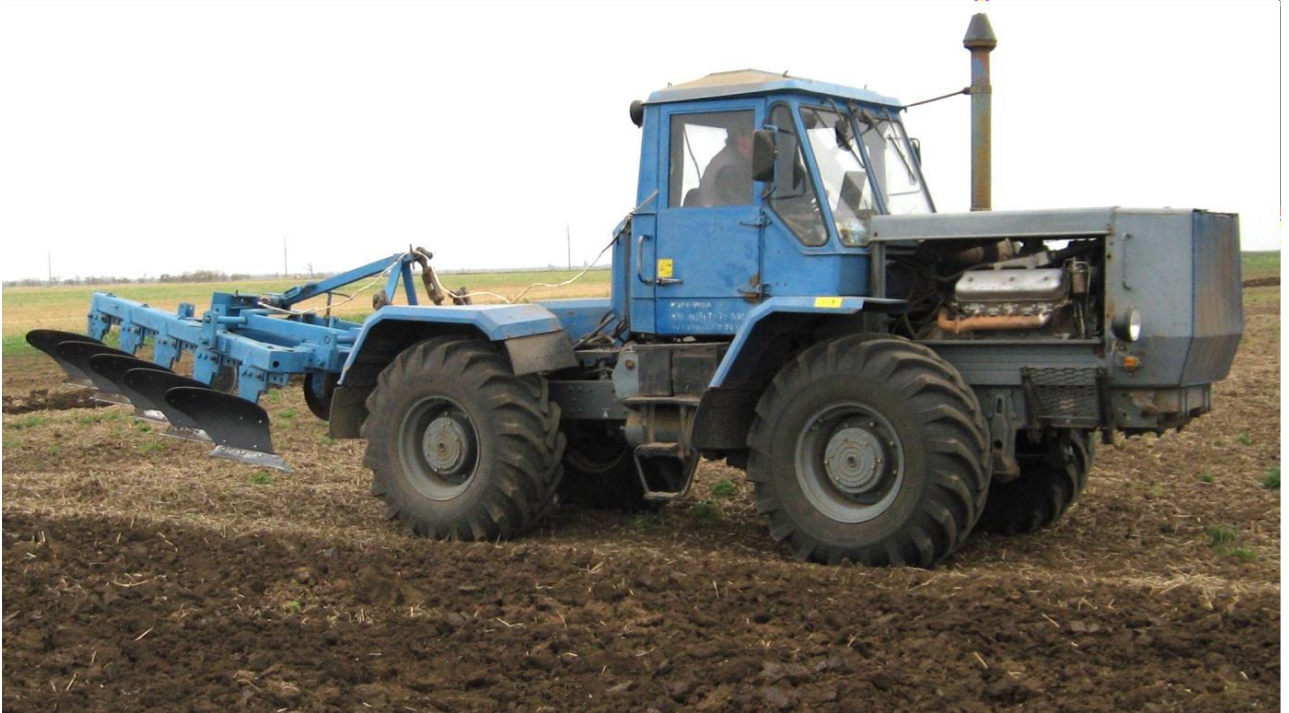
Рис. 3.5. Орний агрегат на основі трактора Т-150К.
