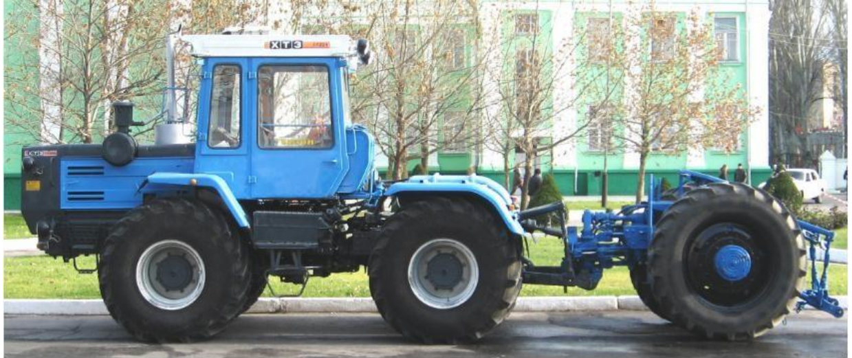
Рис. 2.4. Модульний енергетичний засіб МЕЗ-300 на базі трактора серії ХТЗ-170.
