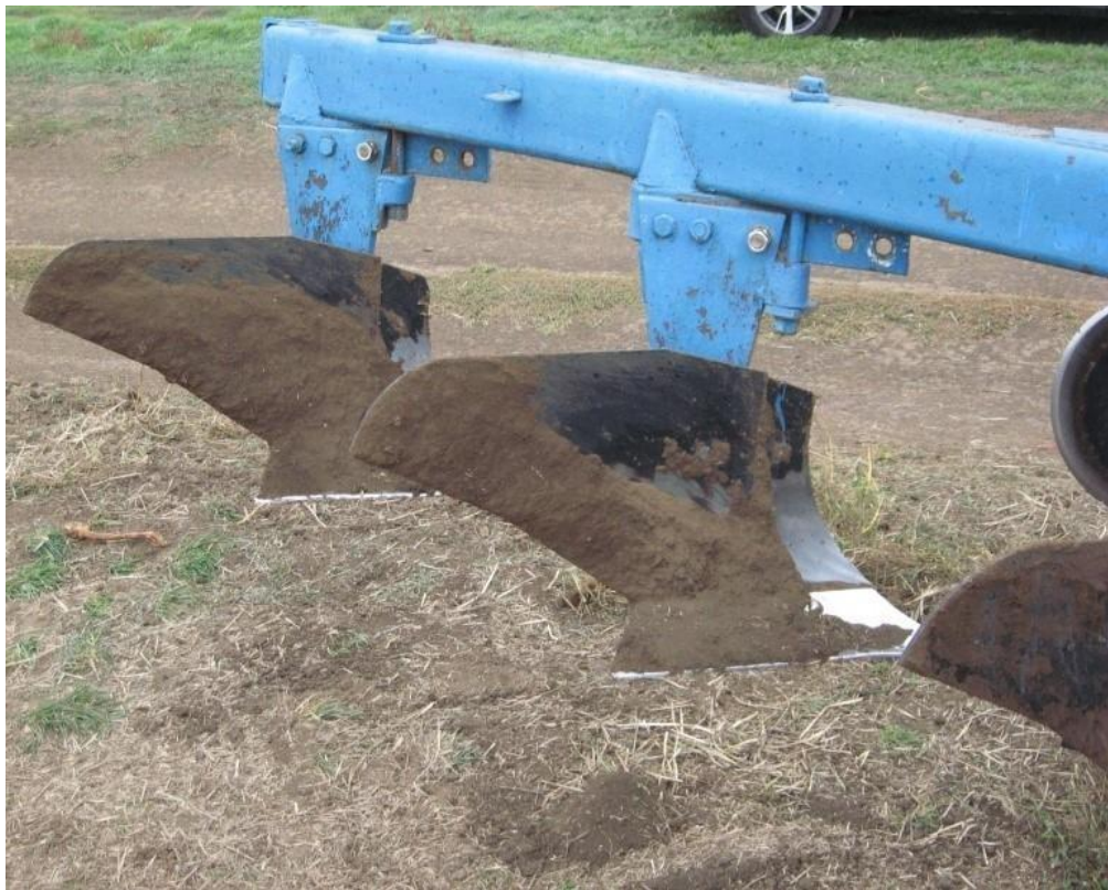
Рис. 3.7. Залипання сталевих полиць плуга ґрунтом.
