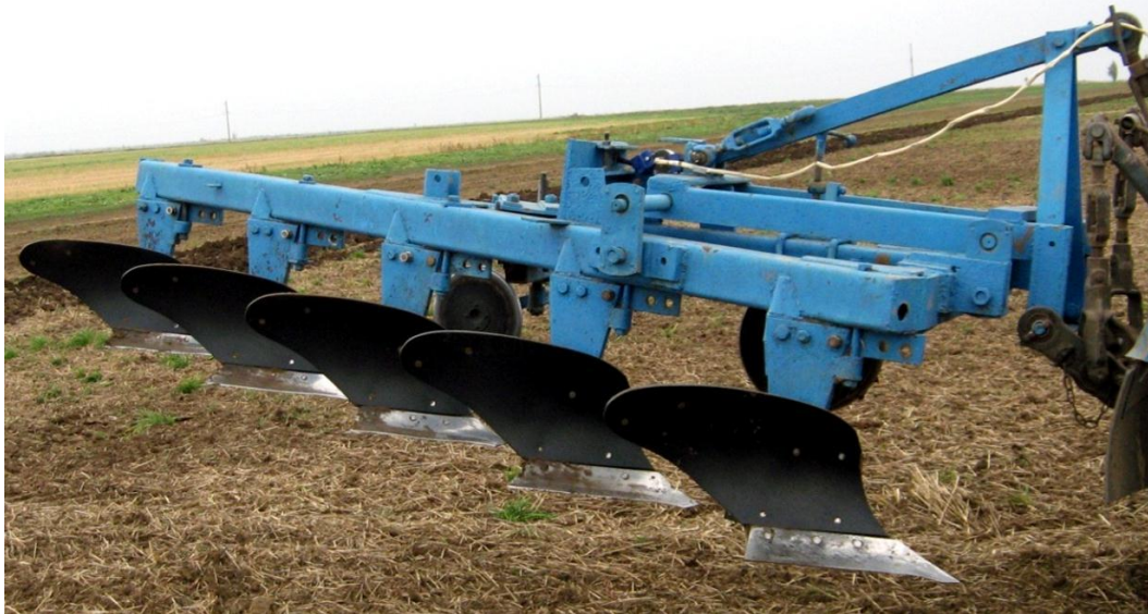
Рис. 3.1. Досліджуваний плуг з робочими органами із нового композитного матеріалу.
