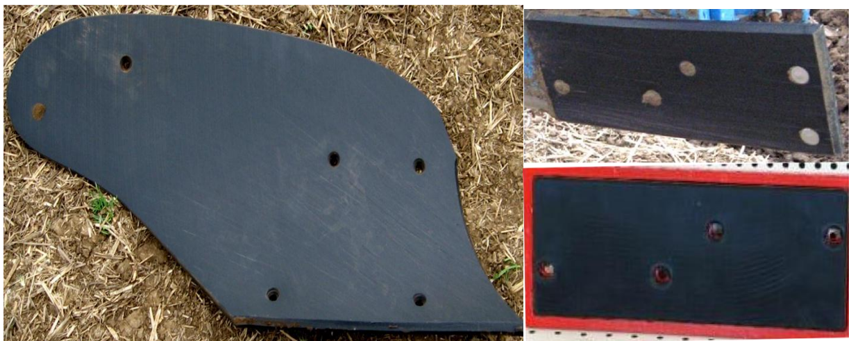
Рис. 2.7. Виготовлені з текрону, полиця та польова дошка.
