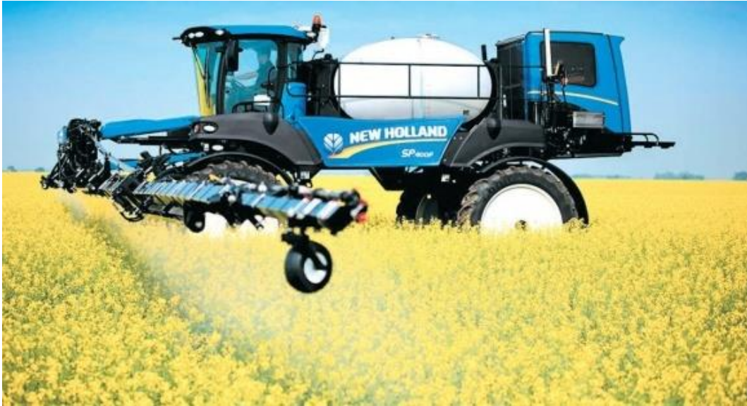
Рис. 3.2. Обприскувач New Holland, модель Guardian, з переднім розташуванням штанги.
