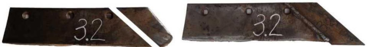
Рис. 3.1. Лінійні розміри лемеша: а) зношеного; б) у стані поставки.
