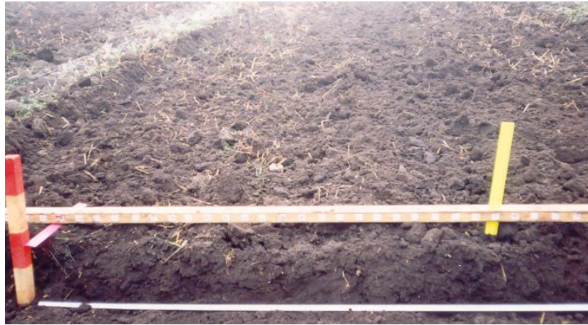
Рис. 2.1. Вимірювання вирівняності поверхні поля на одному з варіантів дослідження якості роботи чизельно-дискового культиватора.
