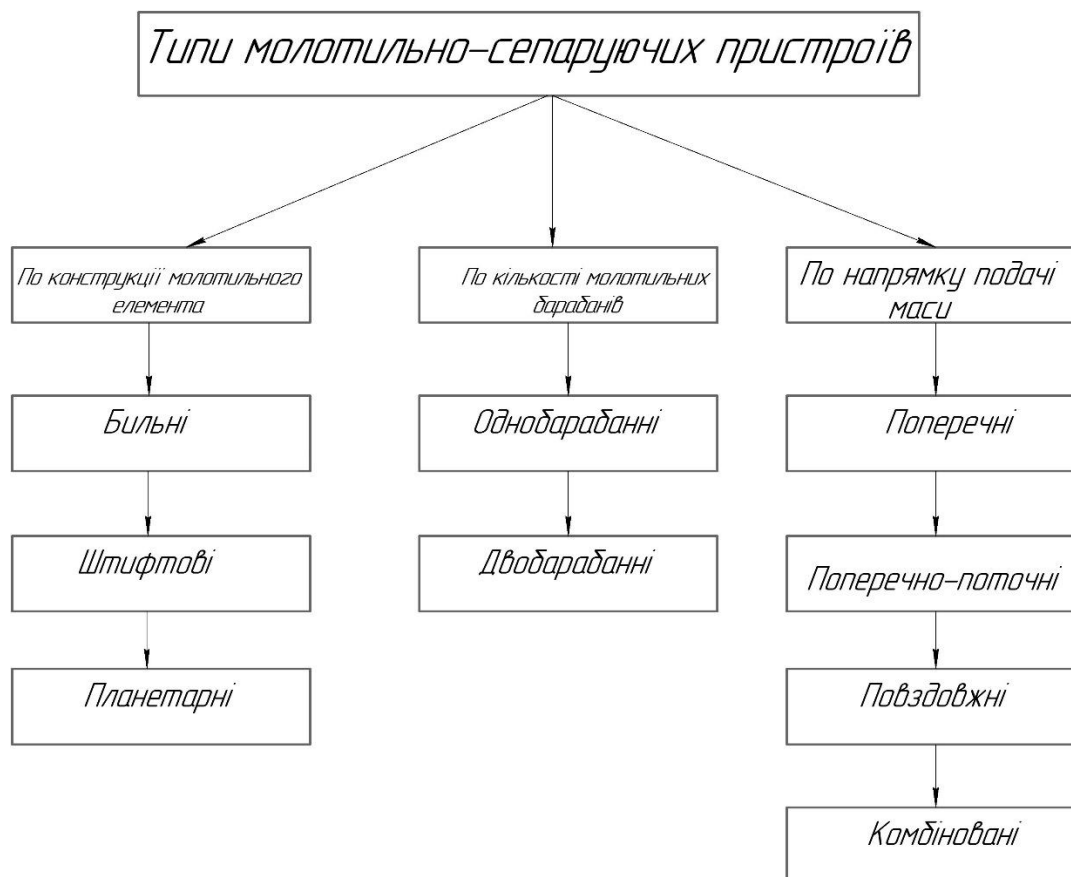
Рис. 1.2. Класифікація молотильно-сепаруючих пристроїв
