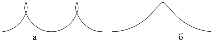
Рис. 2.5. Траєкторія точки леза лопаті ротора
