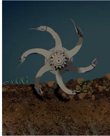
Рис. 2.1. Ротаційний робочий орган вертикального обробітку
