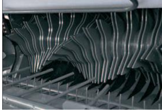
Рис. 1.7. Загальний вигляд ротора Roto Cut фірми CLAAS
