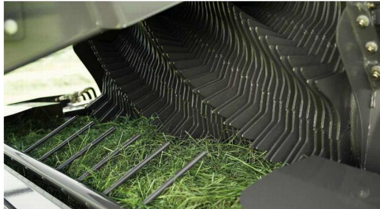
Рис. 1.8. Ротор-подрібнювач машини Quadrant 3400 (загальний вигляд)
