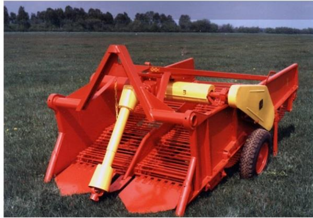
Рис. 1.5. Картоплекопач КТН – 2В
