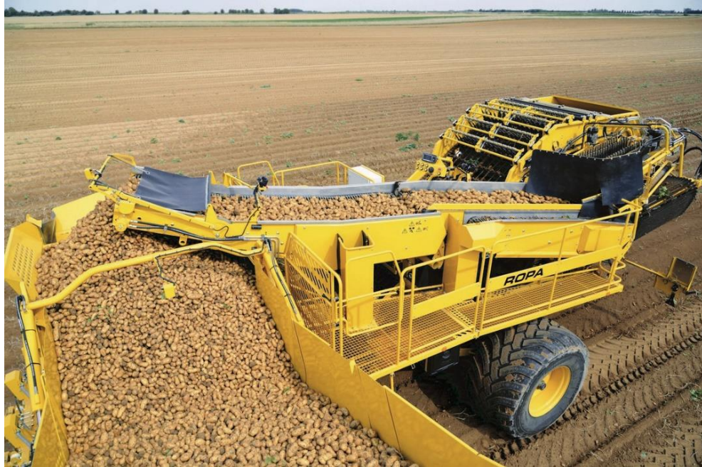
Рис. 1.4. Дворядний картоплезбиральних комбайн модель Ropa Keiler II Classic
