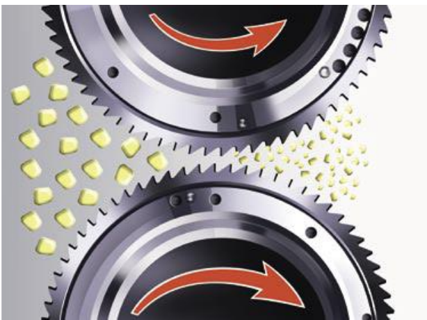
Рис. 1.4. Подрібнююча система CORN CRACKER комбайна CLAAS JAGUAR
