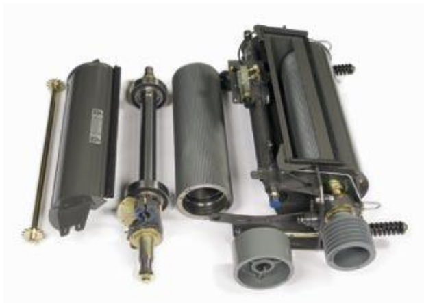
Рис. 1.4. Подрібнююча система CORN CRACKER комбайна CLAAS JAGUAR
