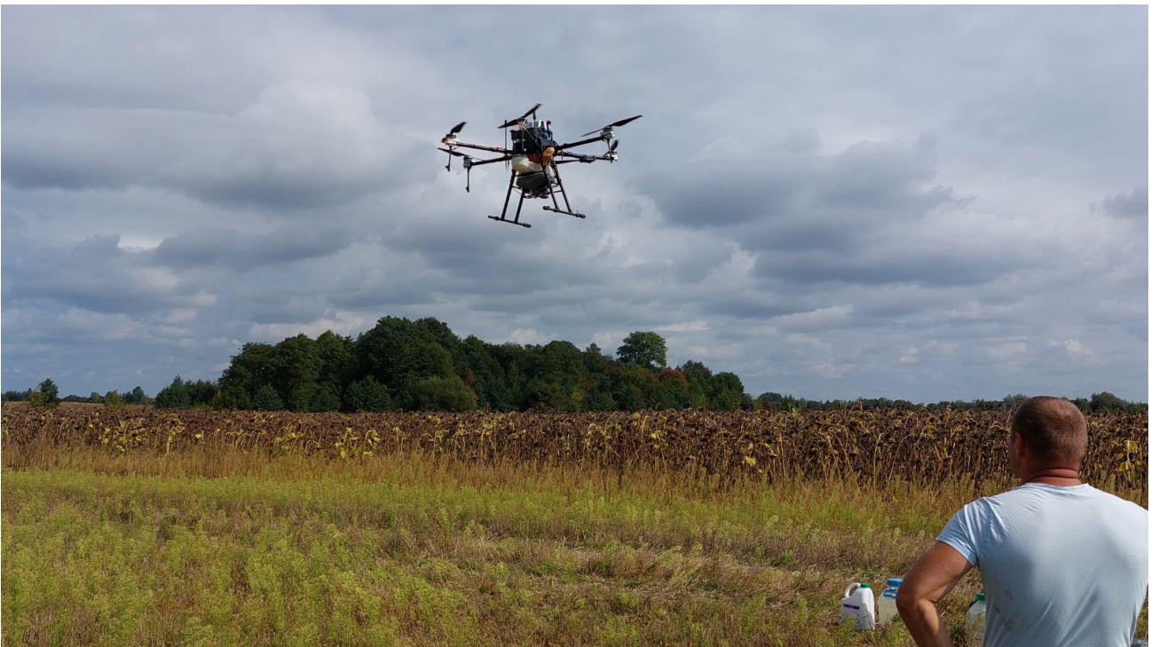
Рис. 1.2. Аграрний мультидрон (гібридний) UAS-25G (належить ТОВ «Джіфлайт») виконує десикацію посівів соняшника (фотографія автора)
