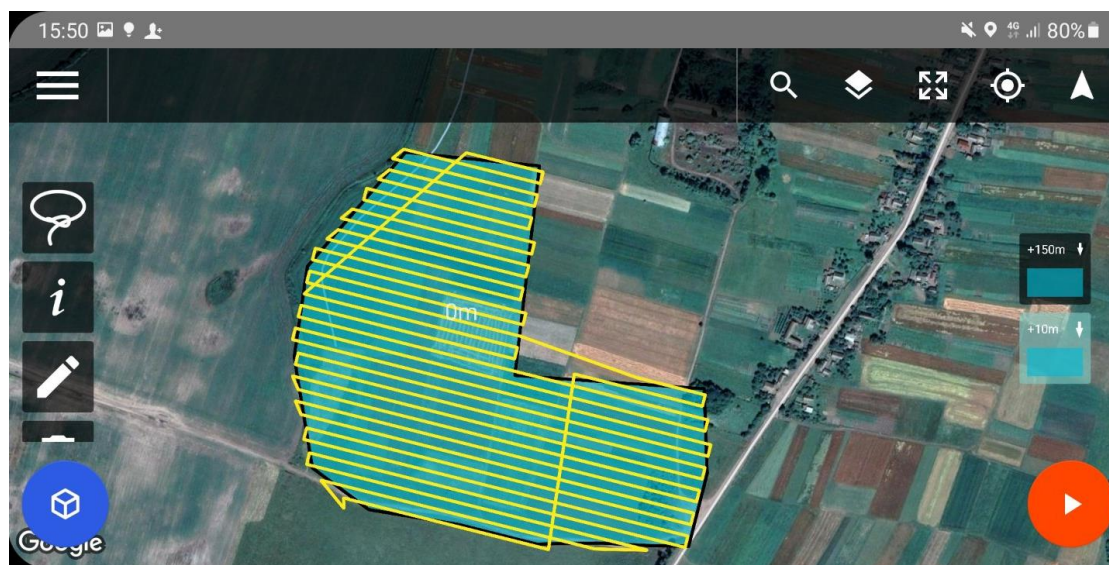
Рис. 2.1. Приклад польотного завдання (місії) внесення пестицидів агродроном для поля зображеного на рис. 1.5 (фото автора)
