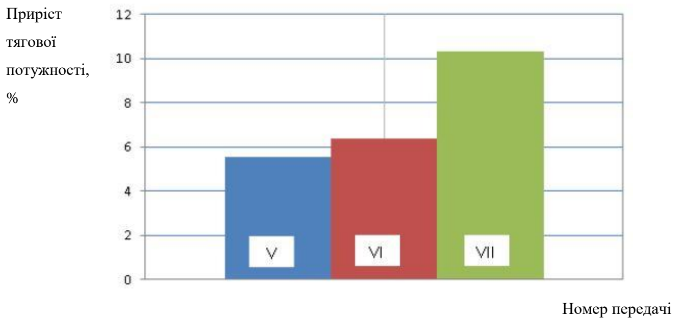
Рис. 3.3. Відносне збільшення тягової потужності трактора МТЗ-82 в агрегаті з сівалкою СЗ-5,4 під час роботи на модифікованому паливі на полі підготовленому під посів.
