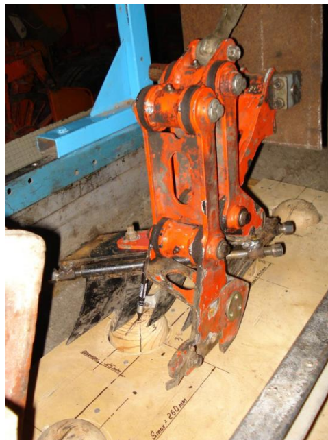
Рис. 2.8. Прототип дорізка гички з гребінчастим копіром: 1 – ґрунтовий канал; 2 – модель головки коренеплоду; 3 – кронштейн; 4 – олівець; 5 – пристосування для кріплення коренеплодів
