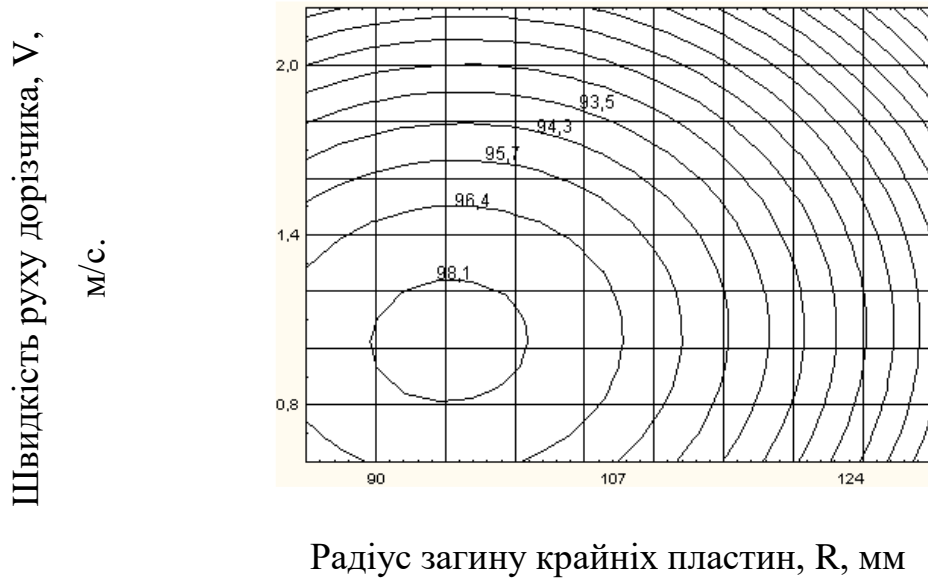
Рис. 2.4. Двовимірні перерізи, що характеризують залежність масової частки нормально обрізаних коренеплодів ( \Delta K_{гг}, \% ) від радіусу загину крайніх пластин гребінчастого копіра ( R , мм) та швидкості руху дорізчика ( v , м/с).
