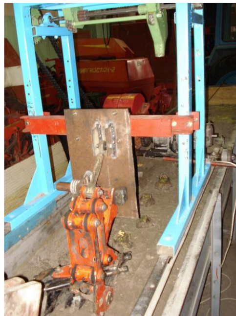
Рис. 2.2. Лабораторна установка (загальний вигляд) для обґрунтування оптимальних та геометричних параметрів дообрізача бадилля з експериментальним гребінчастим копіром.
