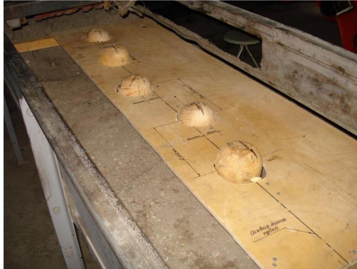
Рис. 2.3. Пристосування для фіксації коренеплодів.
