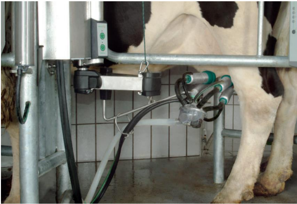
Рис. 1.4 Маніпулятор для машинного доїння фірми WestfaliaSurge (Німеччина) – процес автоматичного машинного додоювання та знімання доїльних стаканів
