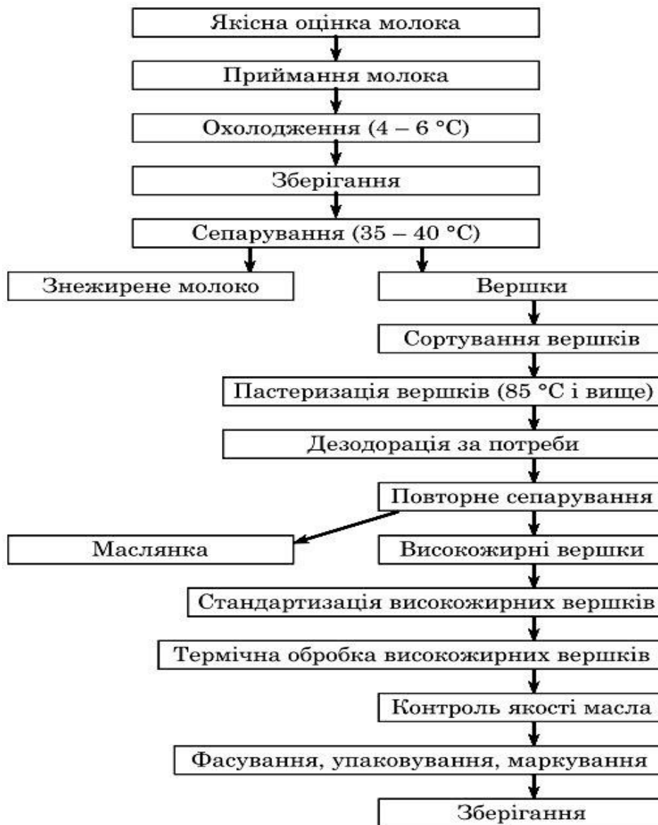
Рис. 4. Схема виробництва масла шляхом перетворення високожирних вершків
