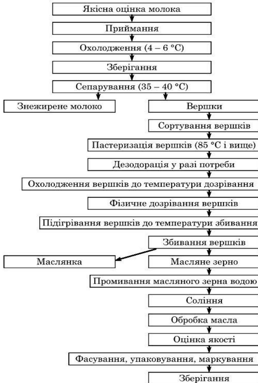
Рис. 5. Схема виробництва солодковершкового масла шляхом збивання вершків
