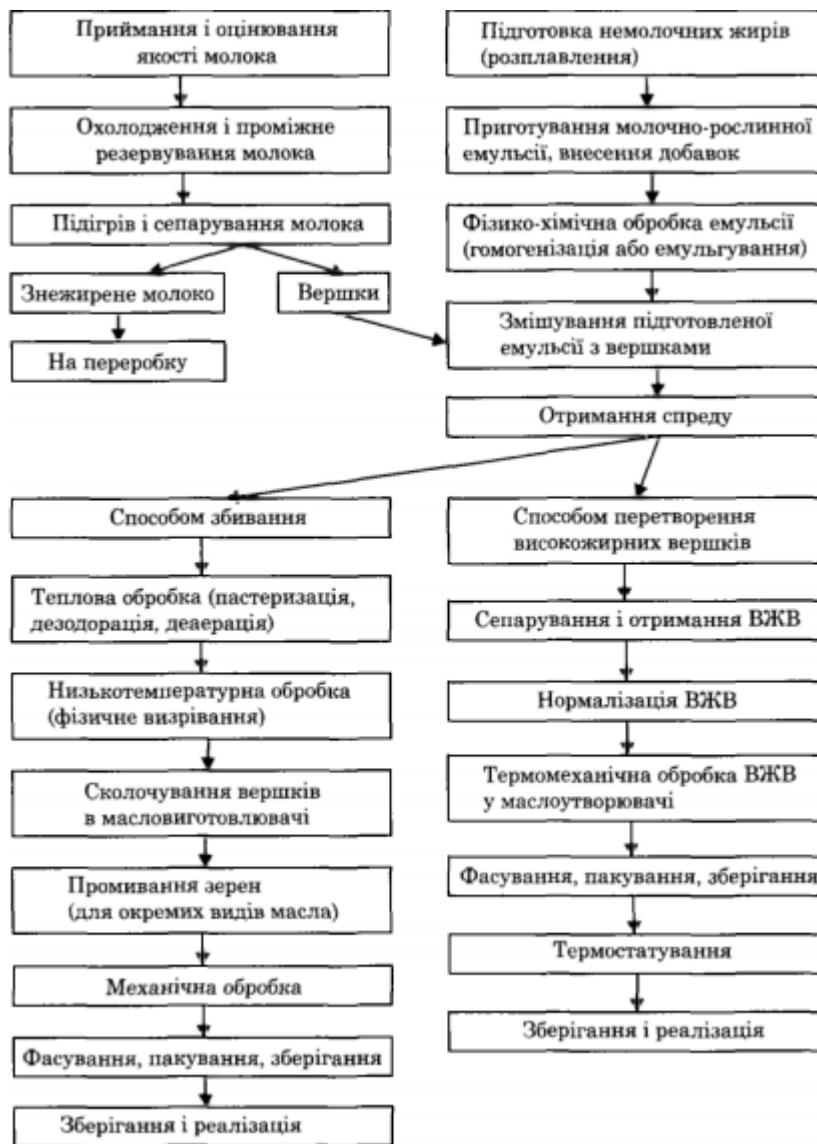
Рис. 6. Технологічна схема виробництва спредів
