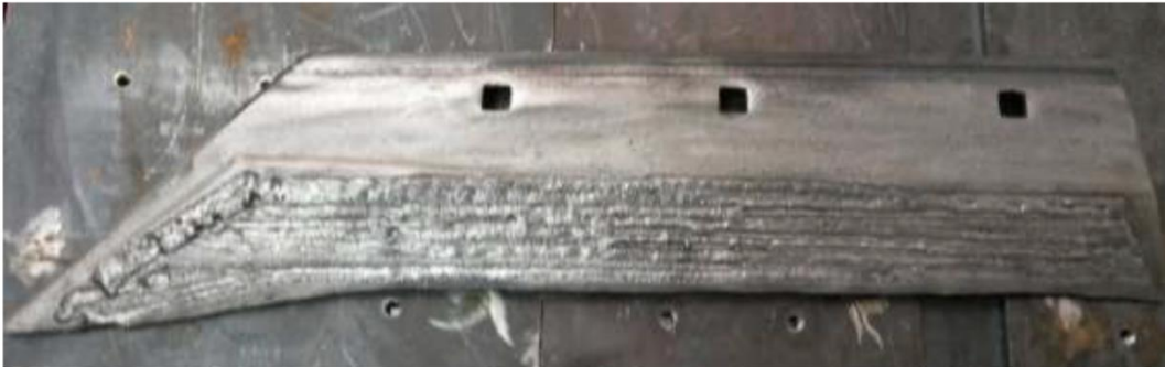
Рис. 3.4. Напилений леміш: до – a ; після плазмового оплавлення – б .
