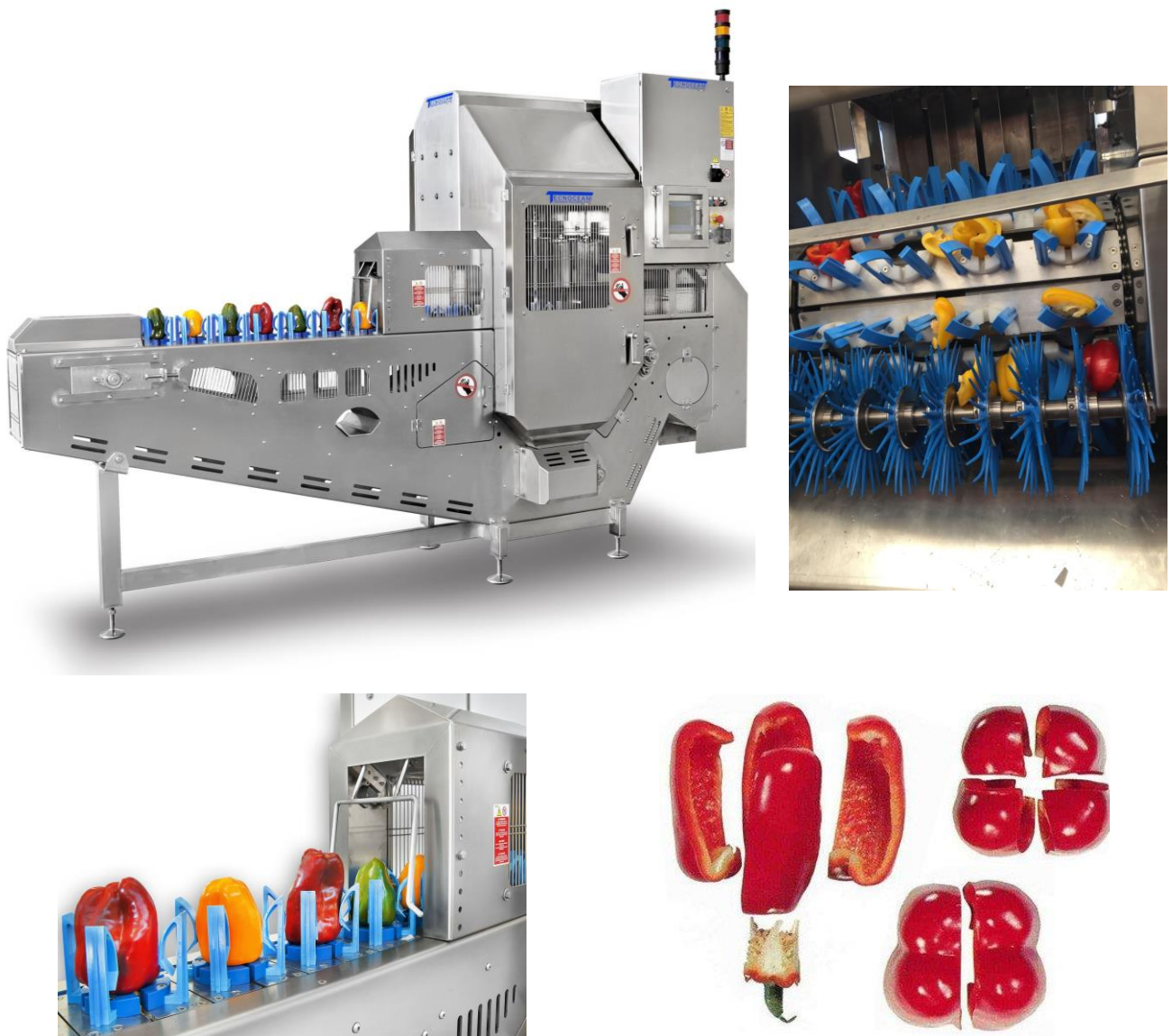
Рис. 1.1. Загальний вигляд машини та спосіб очищення перця болгарського машиною DSP-2P фірми TECNOCEAM (Італія) [1].
