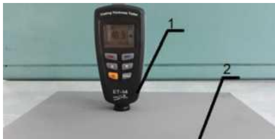
Рис. 2.8. Товщиномір марки ЄВРО ТРЕЙД ЕТ-14 (1 – товщино мір; 2 – пластина металу з нанесеним покриттям).
