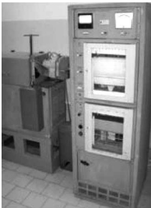
Рис. 2.2. Установка для випробовування на тертя та зношування
