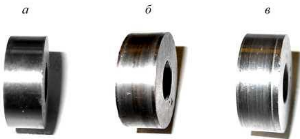
Рис. 2.1. Фотографії зразків з покриттями, що використовувалися в процесі триботехнічних досліджень: a – до початку випробувань; б – після припрацювання з конртілом; в – після закінчення випробувань.
