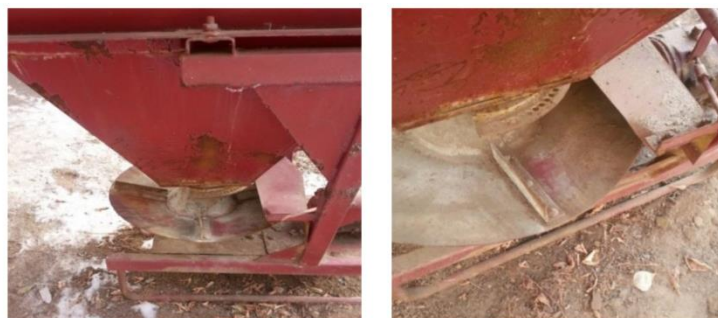
Рис. 3.8. Осередки корозії на розкидачі мінеральних добрив
