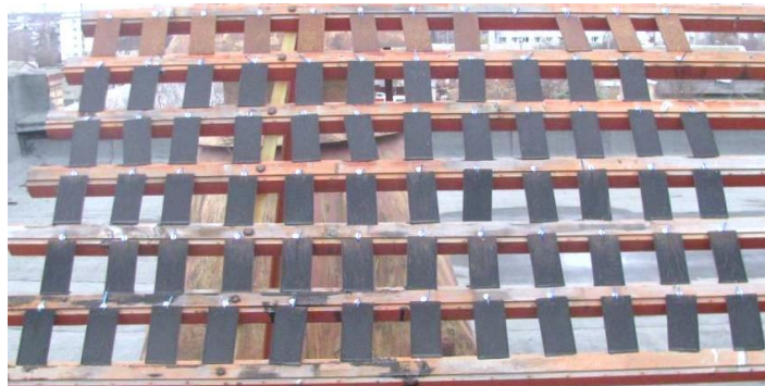
Рис. 2.4. Випробування захисних сумішей на атмосферостійкість
