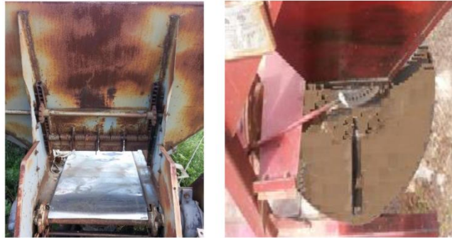
Рис. 3.3. Корозійні руйнування на тукорозкидачах
