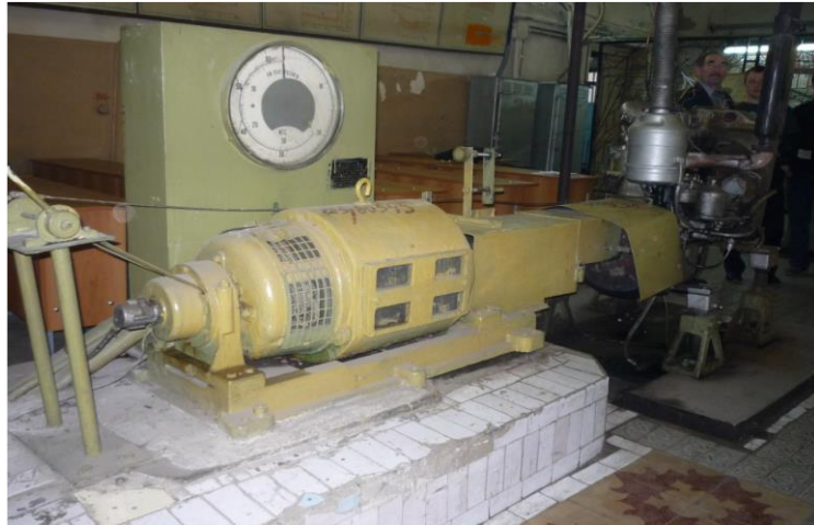
Рис. 2.2. Стенд КИ-5543 для випробування двигунів
