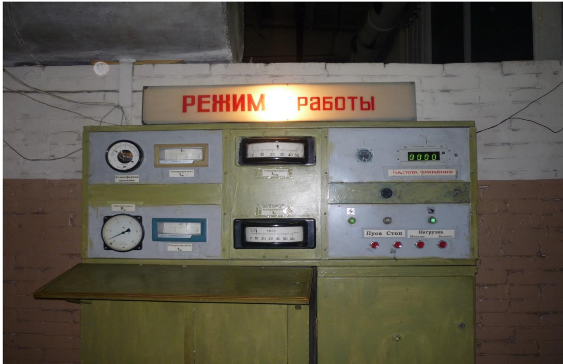
Рис. 2.4. Приладовий щит із контрольними приладами, що відображають режим роботи двигуна на стенді
