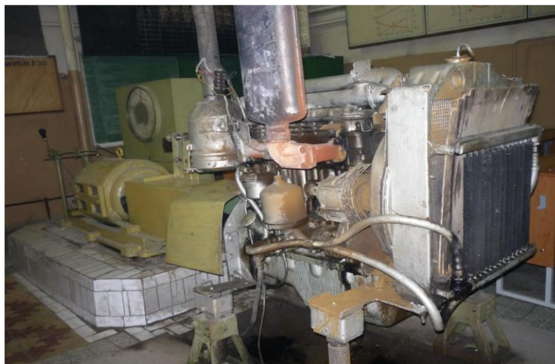
Рис. 2.1. Двигун Д-240, встановлений на стенді КИ-5543
