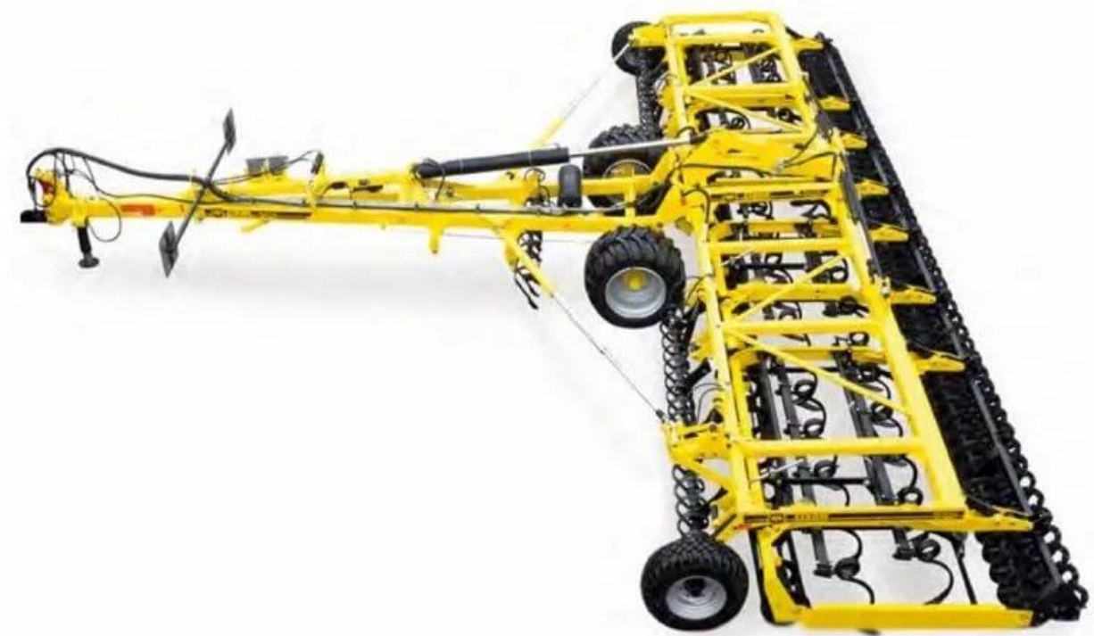
Рис. 2.4. Передпосівний компактор STROM SWIFTER [ https://www.youtube.com/watch?v=mFrpDw0TP1M ]
