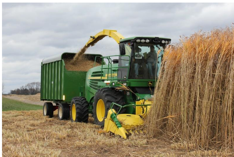
Рис. 2.2. Збирання трав'янистих енергетичних культур кормозбиральним комбайном [3]
