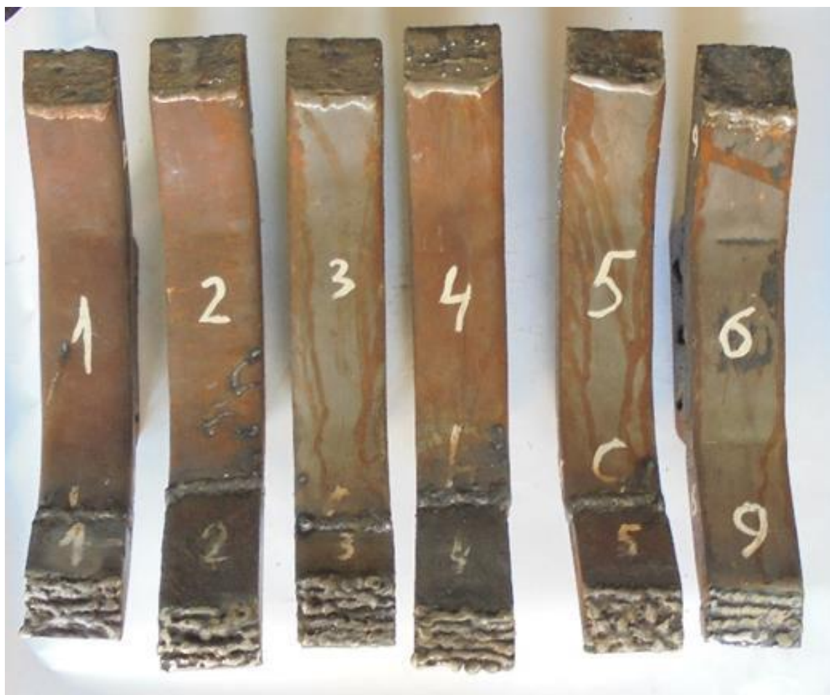
Рис. 3.3. Відновлені долота глибокорозпушувача Gaspardo Artiglio
