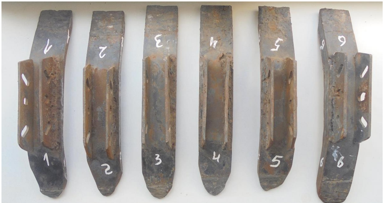
Рис. 3.1. Зношені долота глибокорозпушувача GaspardoArtiglio
