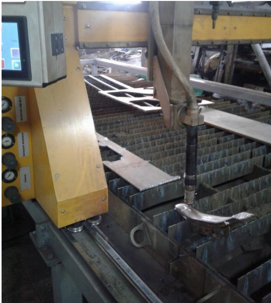
Рис. 3.2 Відрізання зношеної ріжучо-лезової частини долота
