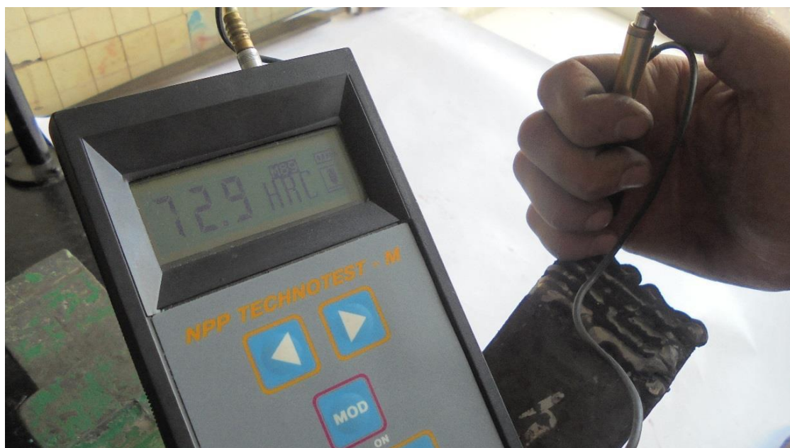
Рис. 3.4. Контроль твердості наплавленої поверхні плазмовим способом
