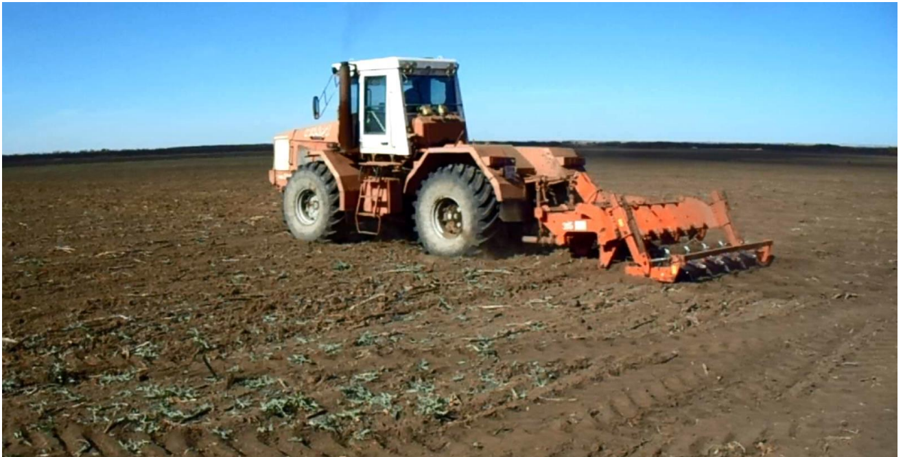
Рис. 3.5. Глибокорозпушувач Gaspardo Artiglio 300/7 в зчпці з трактором К-744 Р1 в процесі роботи
