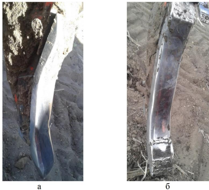
Рис. 3.7. Зношування доліт глибокорозпушувачів Gaspardo Artiglio при напрацюванні 73 га: а – серійного; б – відновленого.
