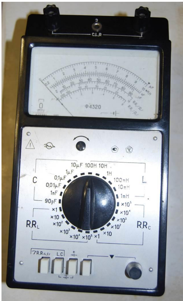
Рис. 2.2. Шигометр Ф 4320 та оригінальний щуп для проведення вимірювань
