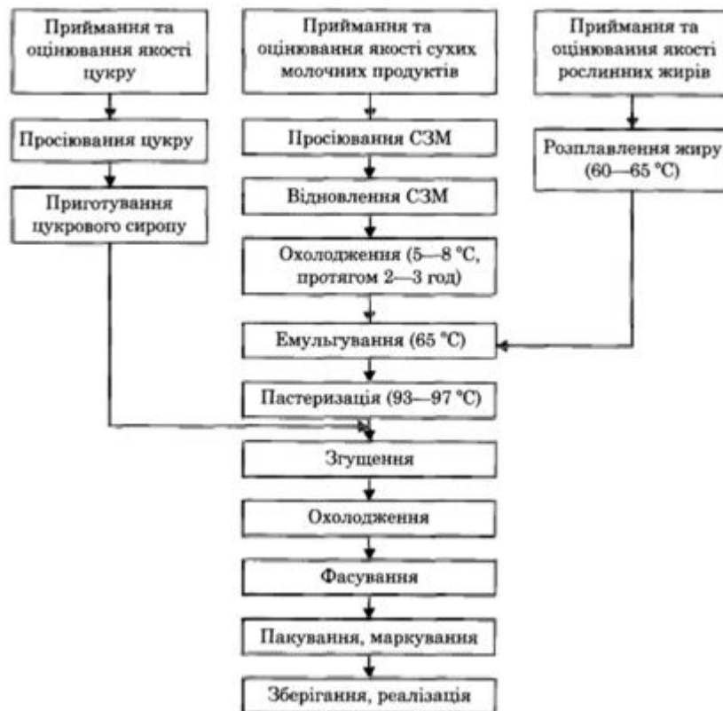
Рис. 17. Технологічна схема виробництва згущених молочних продуктів із цукром і рослинним жиром
