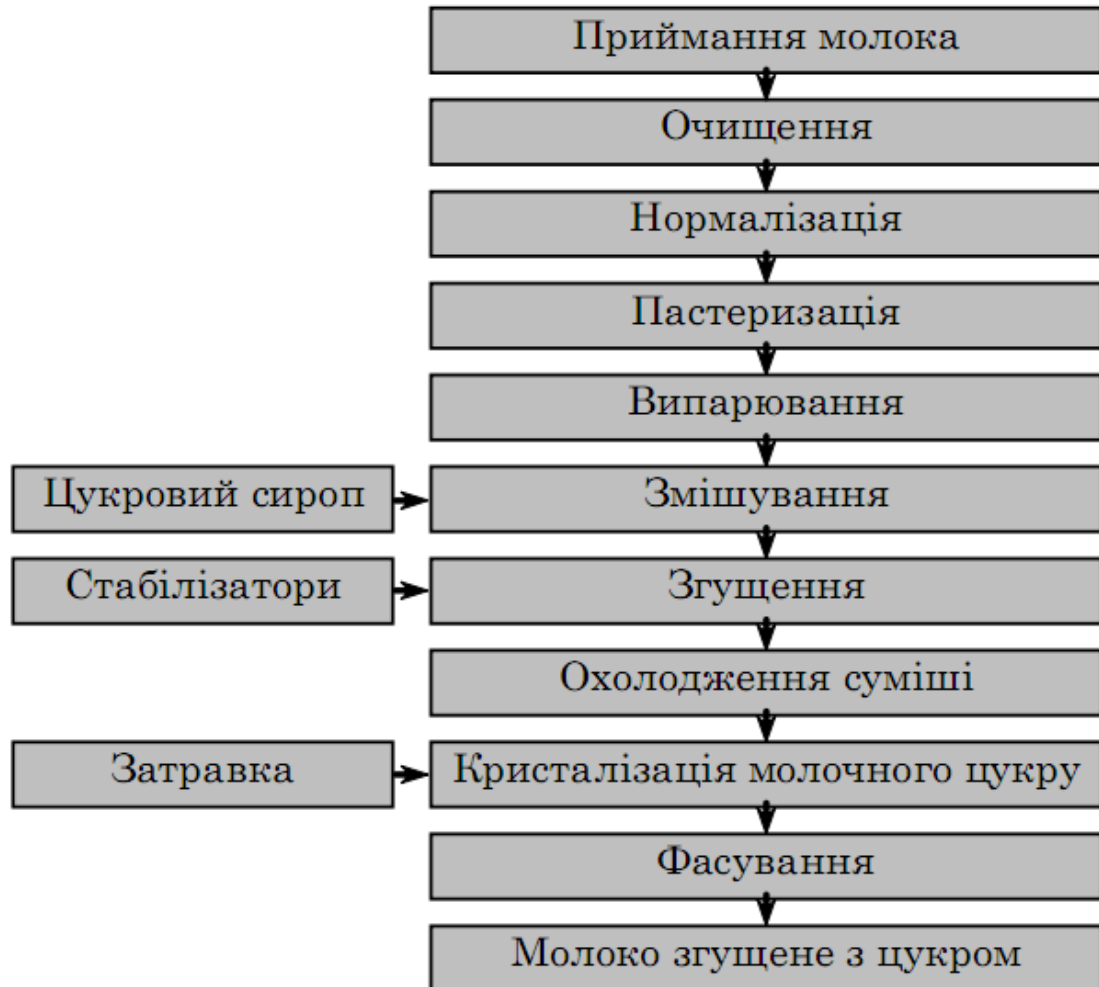
Рис 15. Загальна схема виробництва згущеного молока з цукром
