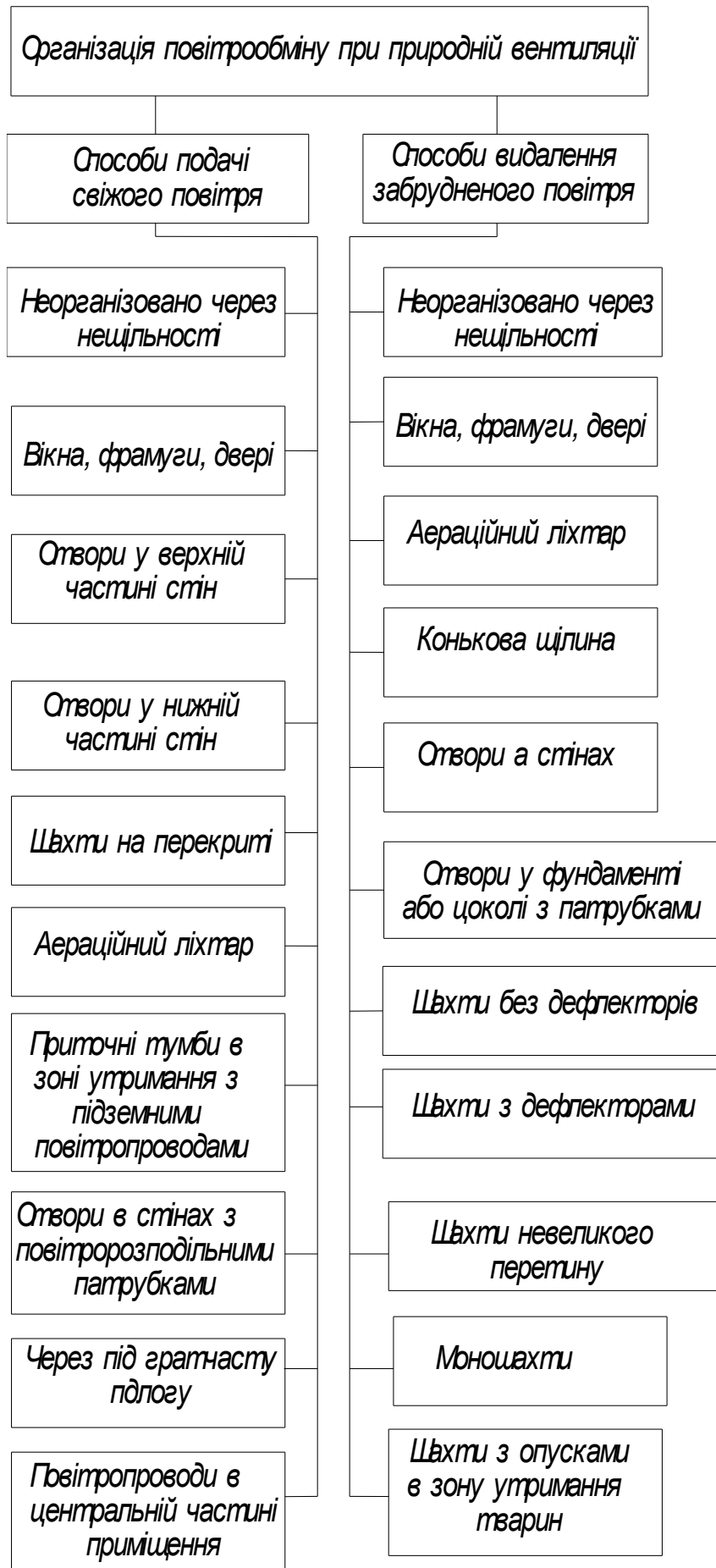
Рис. 1.1 Організація повітрообміну при природній вентиляції
