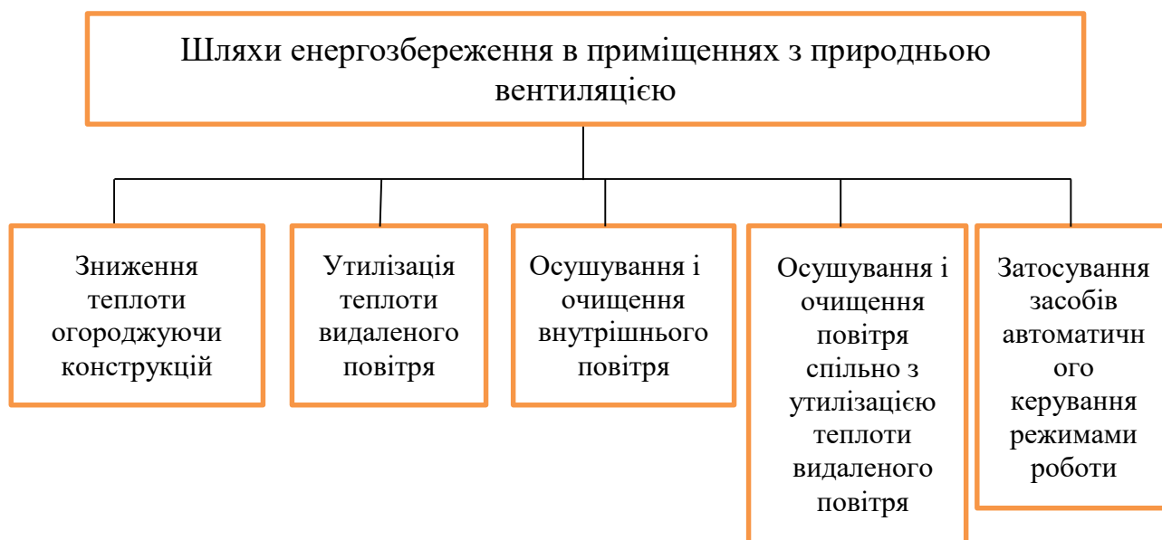
Рис. 1.2. Шляхи енергозбереження в системах із природною вентиляцією
