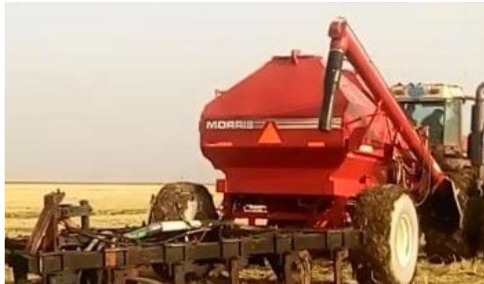
Рис. 2.6. Досліджений польовий агрегат із горизонтальним розподільним пристроєм
