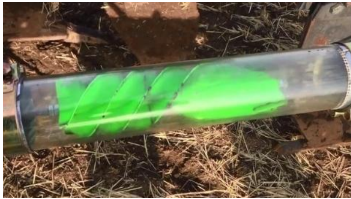
Рис. 2.7. Експериментальний розподільний пристрій Добрива збираються у спеціальні мішечки та зважуються на терезах.
