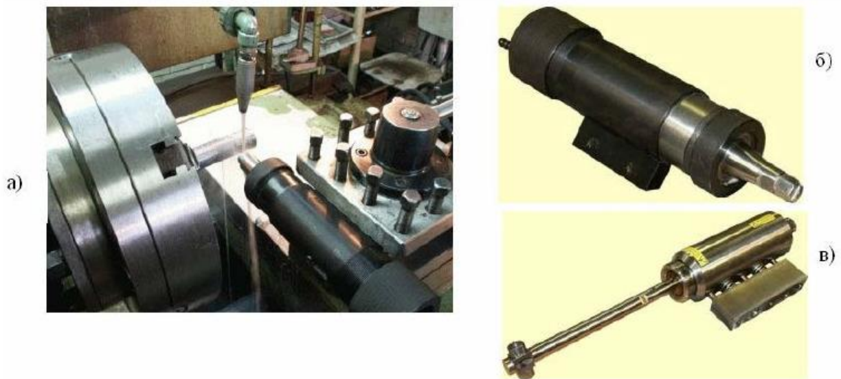
Рис. 1.7. Ультразвукова імпульсна зміцнювально-чистова обробка деталей: а – зміцнення циліндричної деталі на токарному верстаті; б – інструмент обробки зовнішніх поверхонь; в – для обробки внутрішніх поверхонь
