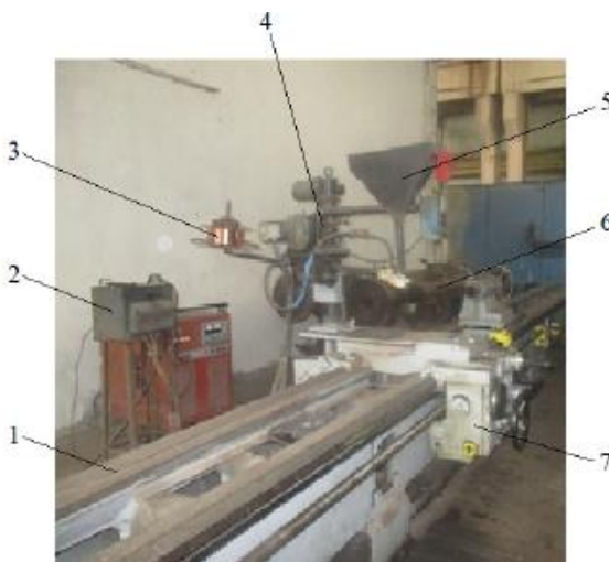
Рис. 1.2. Встановлення автоматичного зварювання під шаром флюсу: 1 – станина; 2 – електрощит; 3 – механізм подачі дроту; 4 – установка наплавлення; 5 – бункер для флюсу; 6 – вал; 7 – супорт верстата
