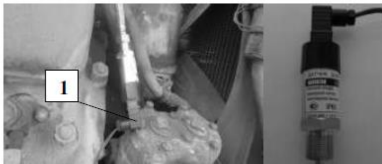
Рис. 2.5. Датчик тиску ПД100-ДІ0.1 та спосіб його встановлення на двигун СМД-62.
