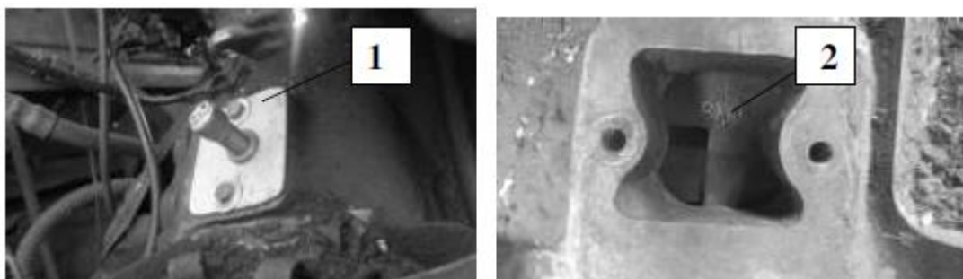
Рис. 2.3. Встановлення датчика положення ВМТ на дизелі СМД-62
