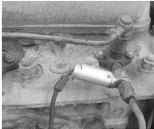
Рис. 2.4. Встановлення датчика тиску у паливо проводі.
