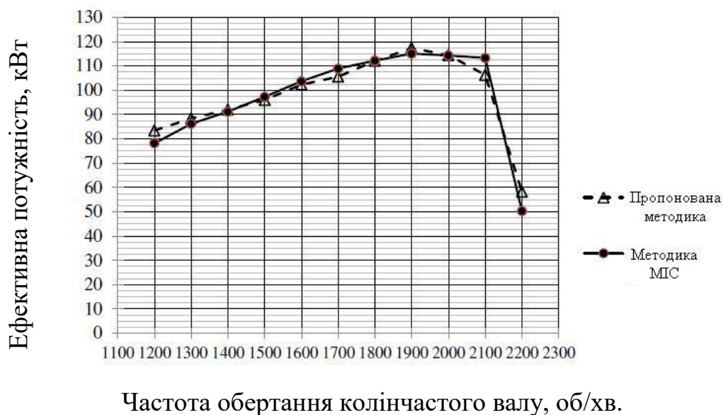
Рис. 3.6. Залежності ефективної потужності від частоти обертання колінчастого валу двигуна № 176721, отримані за стандартною та запропонованою методикою.
