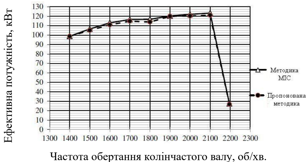
Рис. 3.7. Залежності ефективної потужності від частоти обертання колінчастого валу двигуна № 186416, отримані за стандартною та запропонованою методикою.
