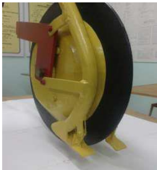
Рис. 2.2. Новий макетний зразок однодискового сошника із симетричними двосторонніми ребрами-борозноутворювачами (вид ззаду).
