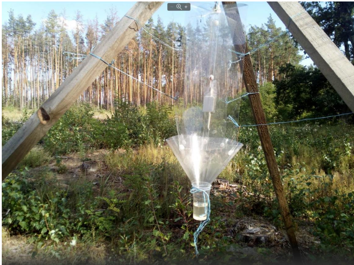
Фото 7. Саморобна пастка із феромонним диспансером «ACUMODOR» встановлена в середньовіковому насадженні у свіжому суборі
