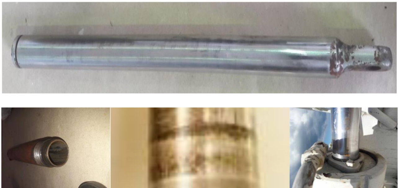
Рис. 1.1. Зовнішній вигляд зношених поверхонь деталей гідросистеми
