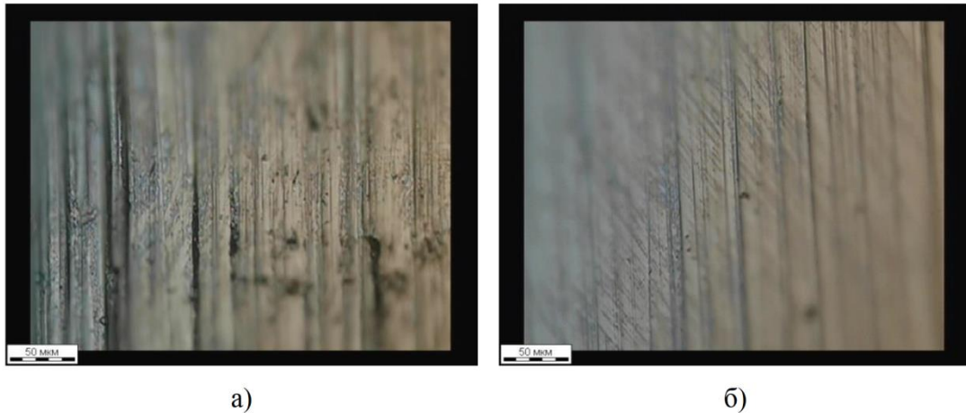
Рис. 3.4. Зовнішній вигляд (через мікроскоп) поверхні пояса золотника гідророзподільника після напрацювання 2000 мотогодин: а) серійного; б) зміцненого
