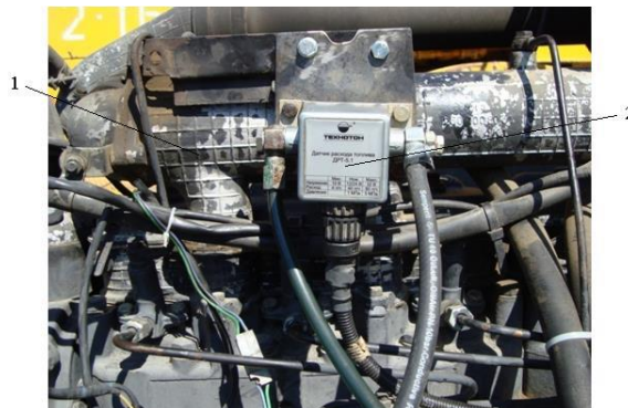
Рисунок 2.5 – Датчик витрати пального ДРТ-5,1: 1 – двигун, 2 – датчик ДРТ – 5,1
