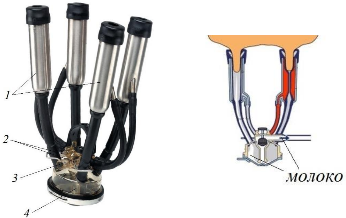
Рис. 1.3. Колектор доїльного апарата із верхнім виведенням молока фірми «DeLaval»: 1 – стакани доїльні; 2 – патрубки розподільної камери; 3 – патрубок молочний; 4 – молочна камера [9, 10].
