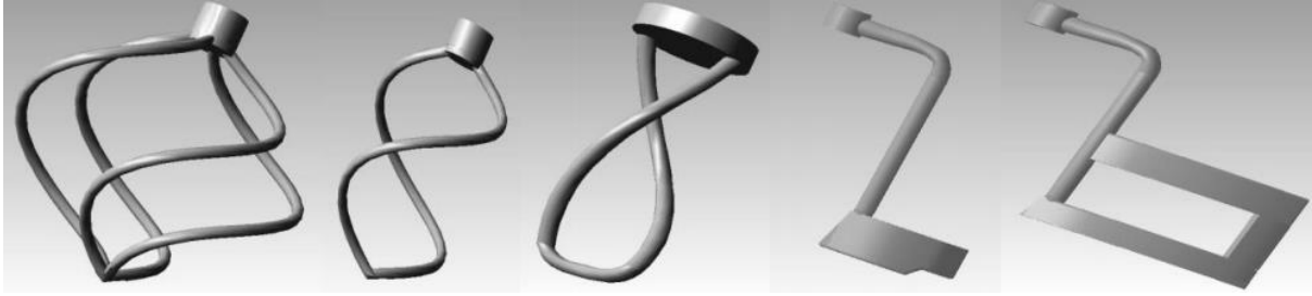
Рис. 1.4. Робочі органи для нерухомих місткостей тістомісильних машин
