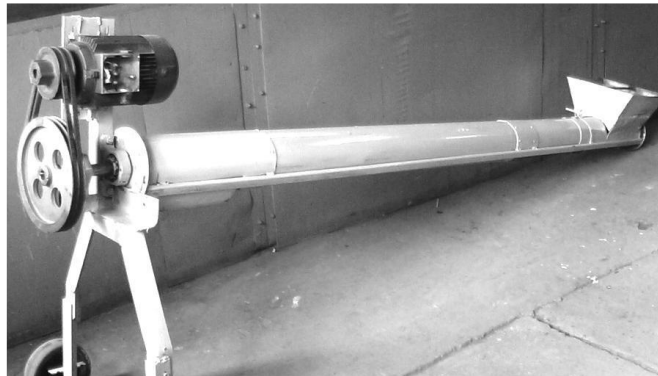
Рис. 3.12. Загальний вид виробничої установки для переміщення суміші посліду з тирсою
