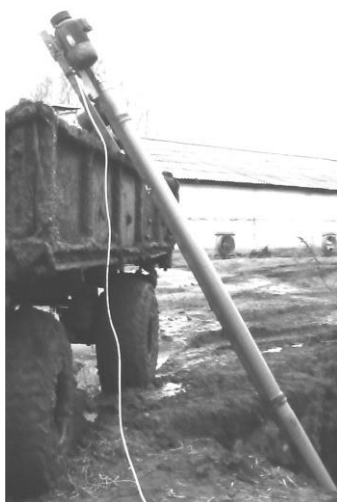
Рис. 2.12. Пристрій для переміщення напіврідкого посліду
