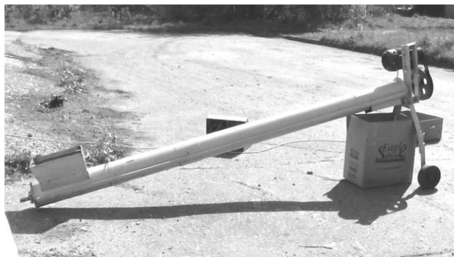
Рис. 2.13. Пристрій для переміщення пташиного посліду в суміші з тирсою
