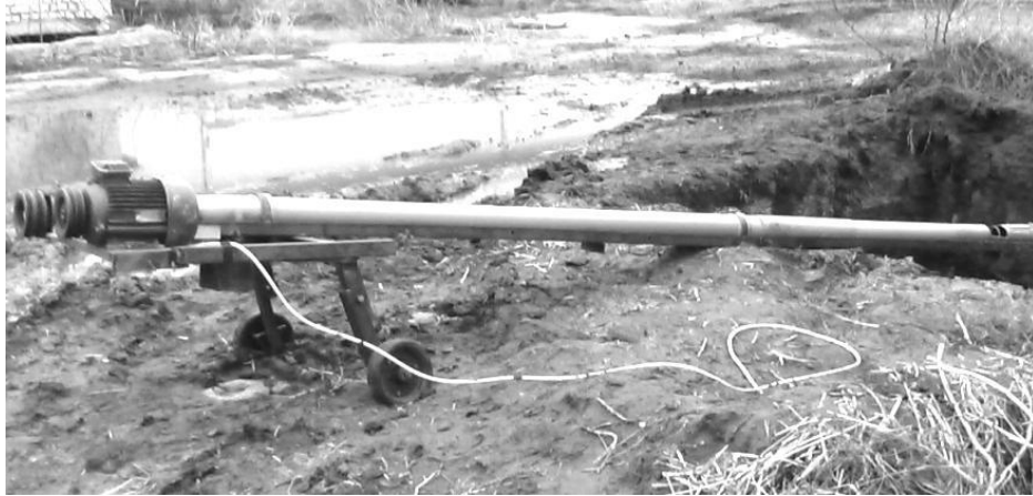
Рис. 3.7. Загальний вигляд пристрою для переміщення напіврідкого та рідкого пташиного посліду
