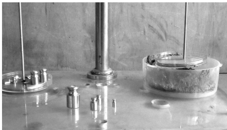
Рис. 2.6. Момент відриву пластини липкостемера від рідкого пташиного посліду
