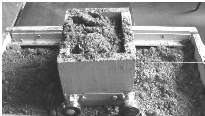
Рис. 2.8 Трибометр у процесі досліджень
