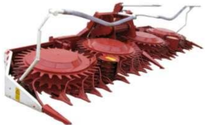
Рис. 1.7. Роторна жнивварка ЖР-6000 з ротаційним різальним апаратом
