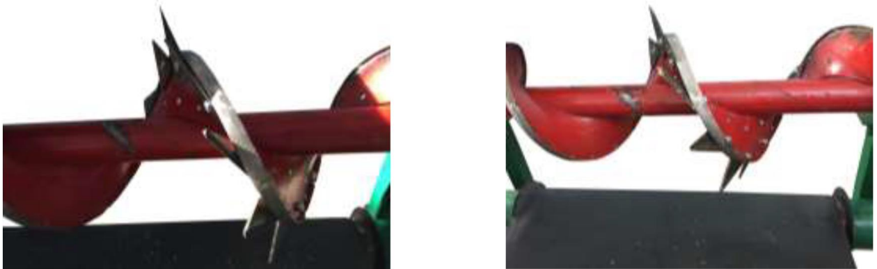
Рис. 2.16. Шнековий рiжучий апарат без рiжучої пластини з рiжучими сегментами трикутної форми
