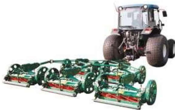
Рис. 1.6. Косарка Hydraulic TG4650 з барабанним різальним апаратом
