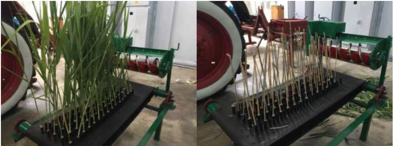
Рис. 2.15. Стебла очерету, закріплені на транспортері: а – вологі; б – сухі (підпiрний зрiз)
