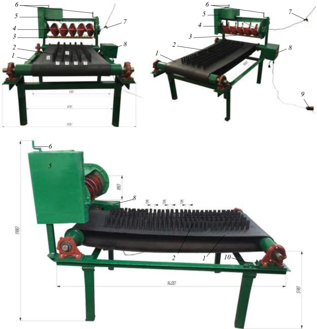
Рис. 2.11. Лабораторний стенд: 1 – транспортерна стрічка; 2 – фіксатор; 3 – ніж; 4 – шнек; 5 – привід шнека; 6 – гвинт для зміни висоти підйому шнека; 7 – пристрій регулювання частоти обертання шнека; 8 – електропривод; 9 – пристрій регулювання швидкості переміщення транспортера; 10 – натяжний пристрій
