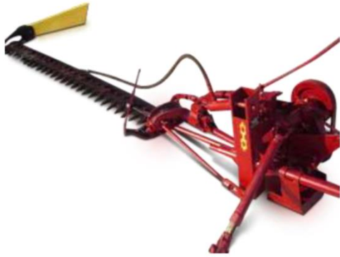
Рис. 1.2. Косилка КСФ-2,1 з сегментним ріжучим апаратом
