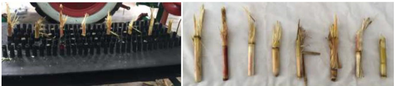
Рис. 3.9. Результати вивчення різання стебел кукурудзи з вологістю зерна 18 % (безпідпирний зріз із ріжучими сегментами з висотою розташування вістря над кромкою шнека 15 мм)
