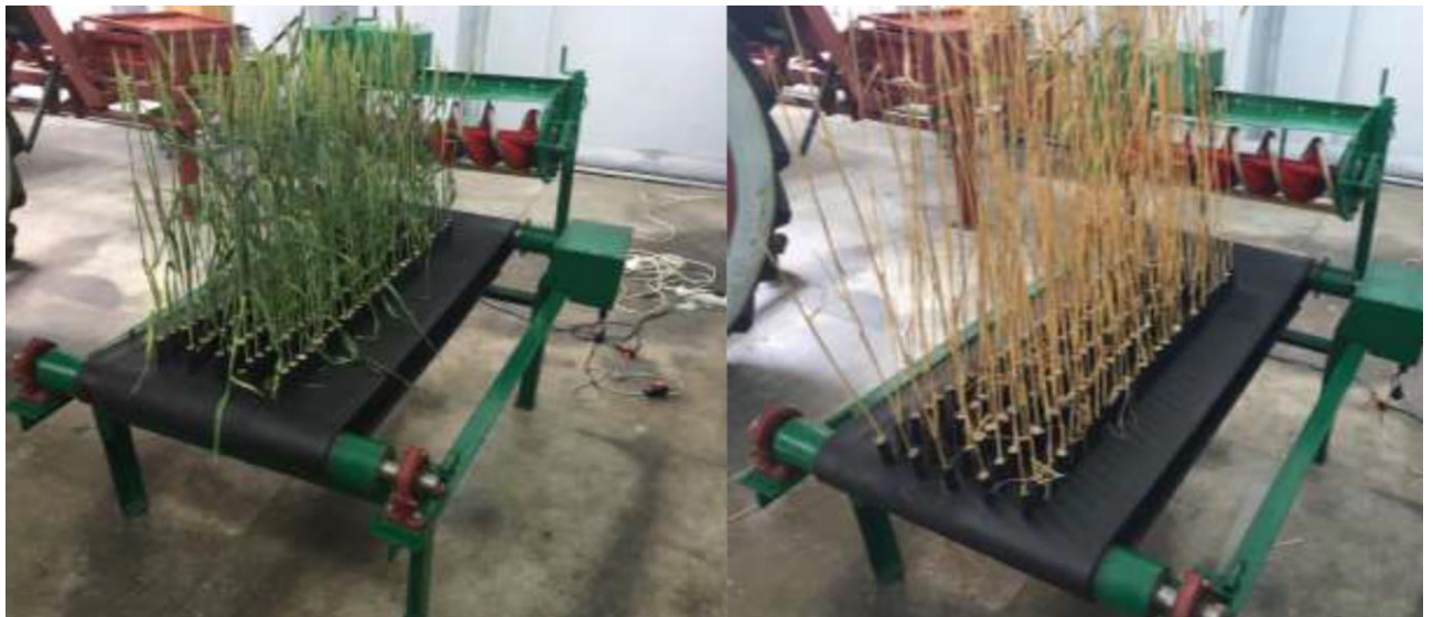
Рис. 2.14. Стебла пшениці, закріплені на транспортері з вологістю зерна: а – 30 %; б – менше 8% (підпірний зріз)
