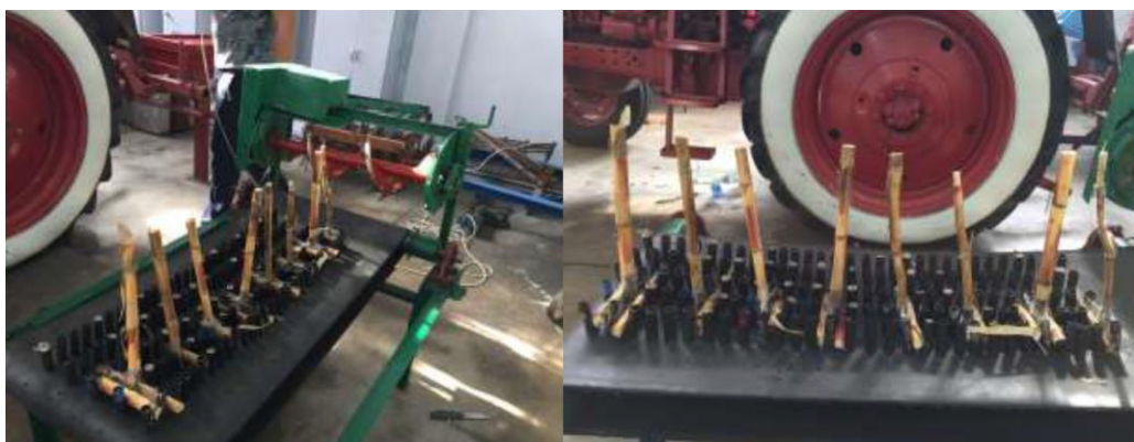
Рис. 2.18. Вивчення різання стебел кукурудзи з вологістю зерна 18 % (безпідпирний зріз з ріжучими сегментами з висотою вістря над кромкою шнека 45 мм, кут нахилу леза сегмента до дотичної витка шнека 45°)
