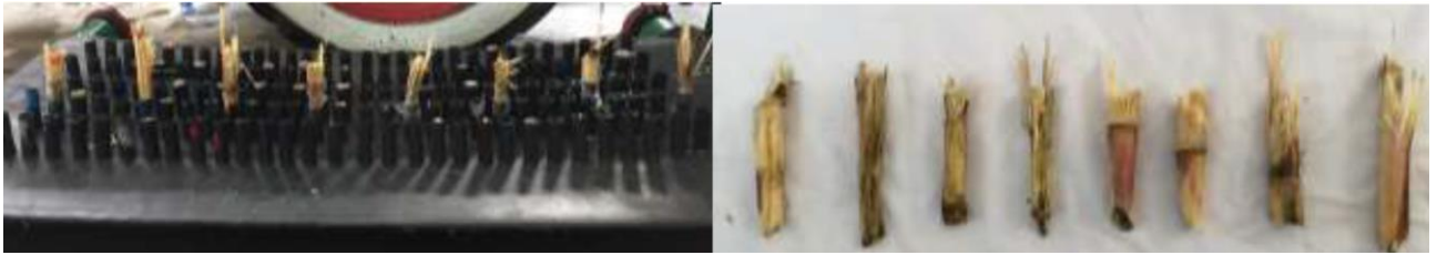
Рис. 3.10. Результати вивчення різання стебел кукурудзи з вологістю зерна 18 % (безпідпирний зріз із ріжучими сегментами з висотою розташування вістря над кромкою шнека 45 мм)
