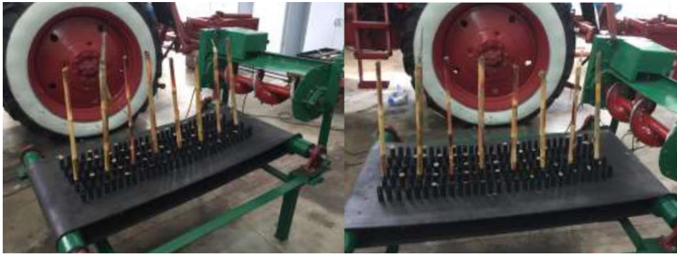
Рис. 2.17. Вивчення різання стебел кукурудзи з вологістю зерна 18 % (безпідпирний зріз із ріжучими сегментами з висотою розміщення вістря над кромкою шнека 15 мм).
