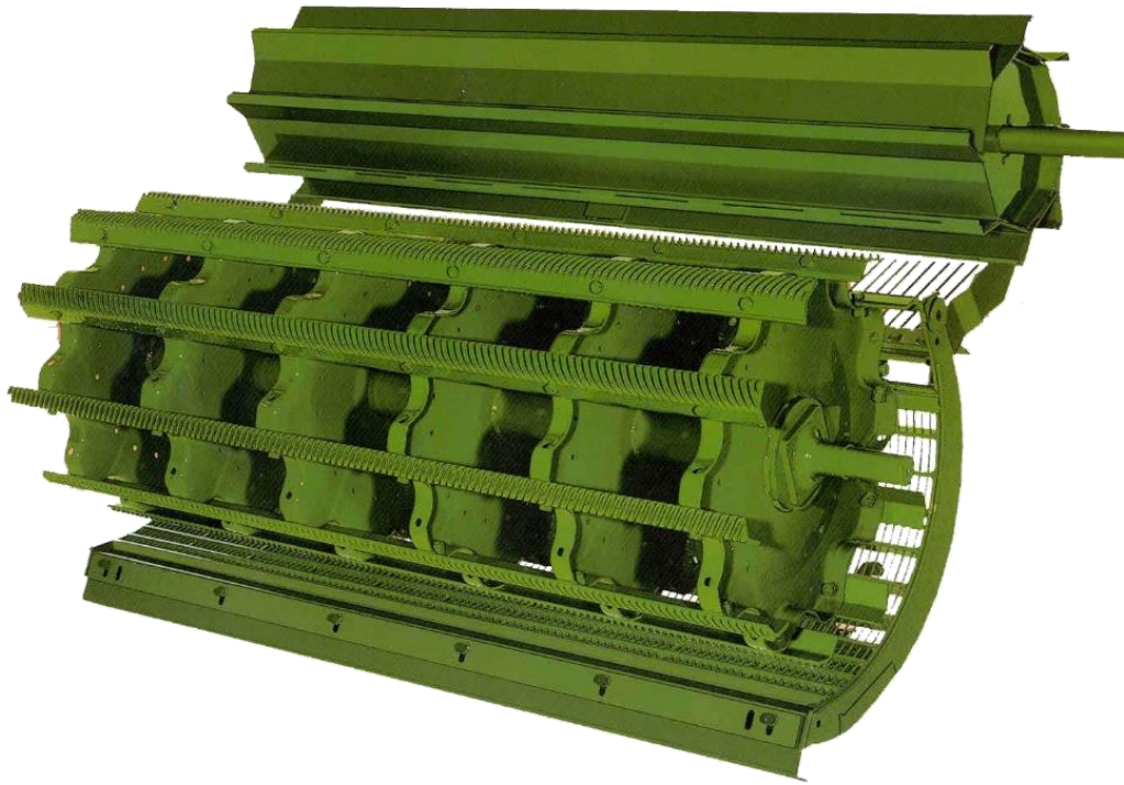
Рис. 2.1. Молотильно-сепаруючий пристрій комбайна John Deere [8]
